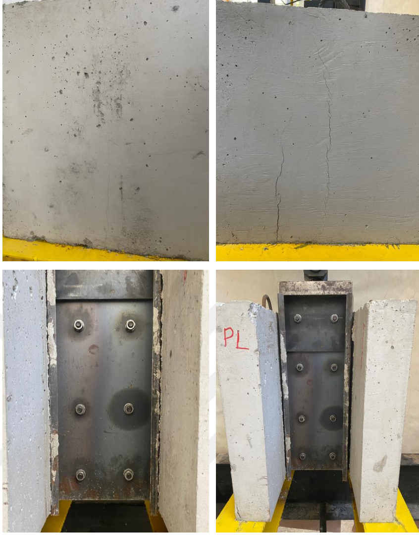
Şekil 56. PO-PL elemanında deney esnasında meydana gelen hasarlar
