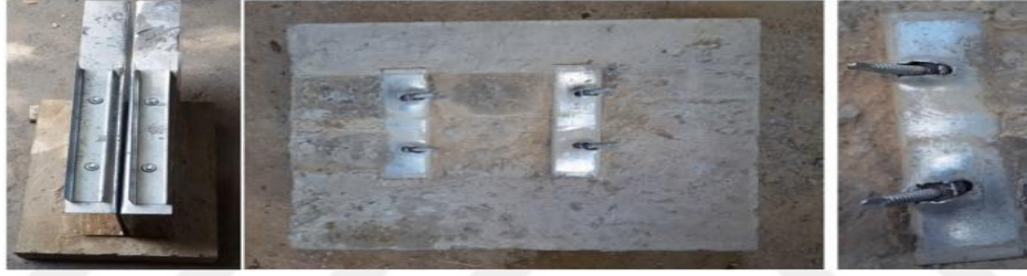
Şekil 5. Bağlantı elemanı detayı ve deney sonu görüntüsü (Hosseinpour vd., 2021)
