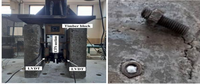
Şekil 9. Deney düzeneği ve deney sonu görüntüsü (Ataei vd., 2023)
