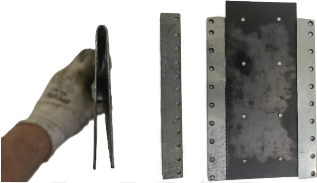
Şekil 33. U şekilli 0.5 mm kalınlığında sac kapak
