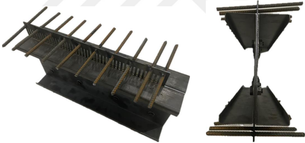
Şekil 32. Beton dökümüne hazır hale getirilmiş PO-PL elemanı
