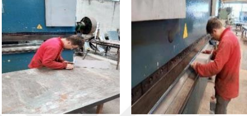
Şekil 28. 1.5 mm sacların bükülüp C enkesitli profil haline getirilmesi
