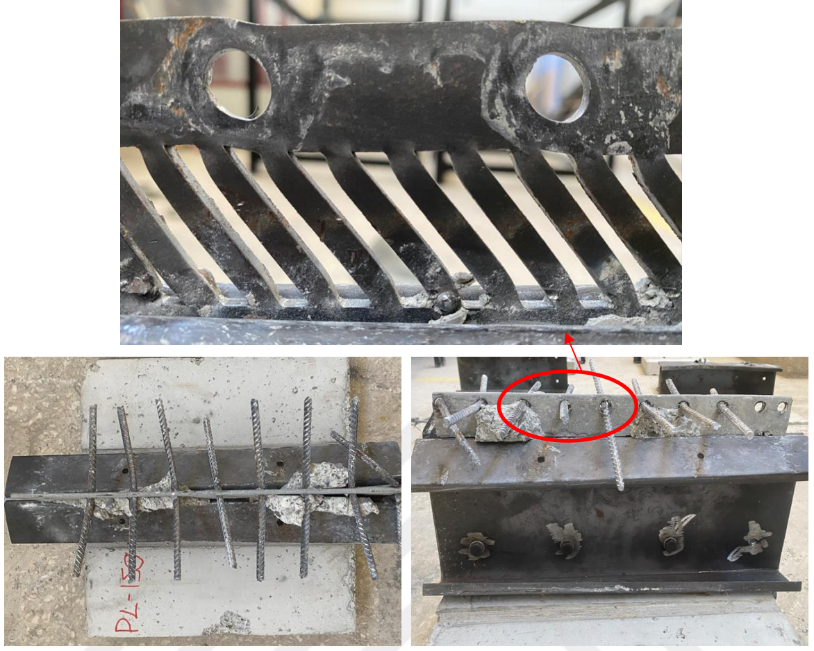
Şekil 59. PO-PL-ISO’da hasar dağılımı
