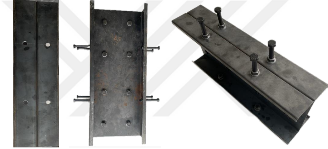
Şekil 30. Cıvatalı kayma bađlantı elemanının kiriş bařlıđına montajı
