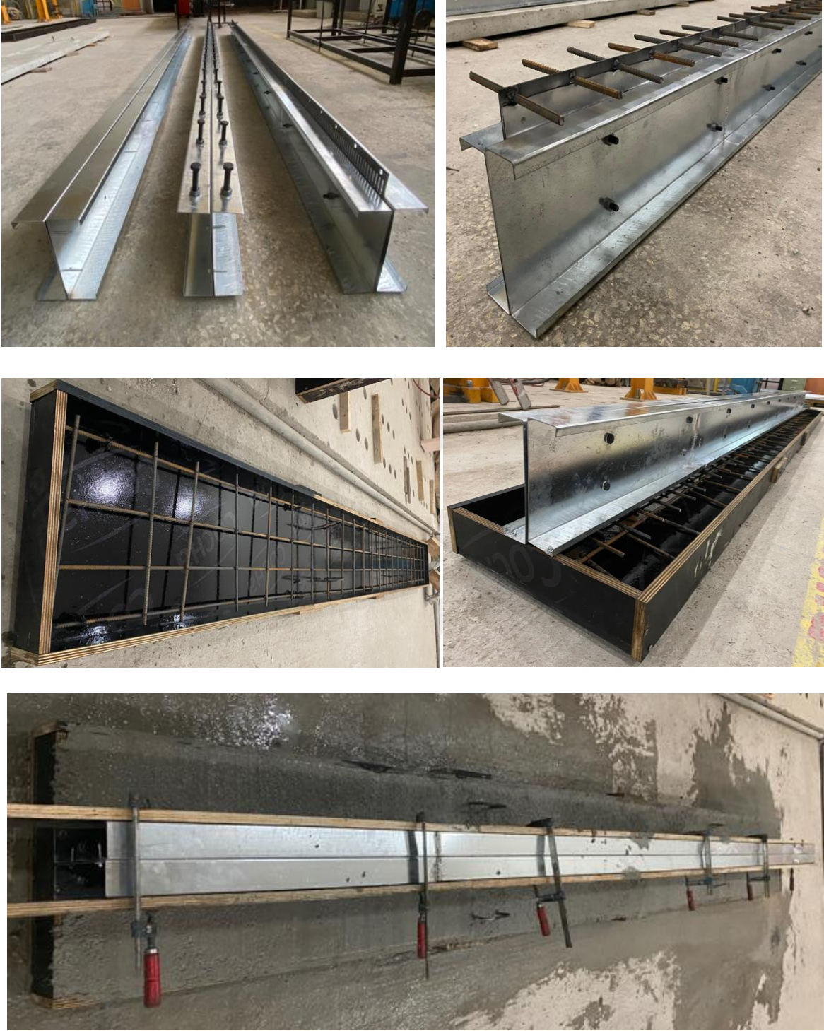
Şekil 42. Eğilme deney elemanlarının üretimine ait bazı görseller
