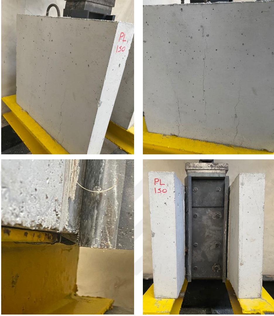
Şekil 58. PO-PL-ISO elemanında deney esnasında meydana gelen hasarlar
