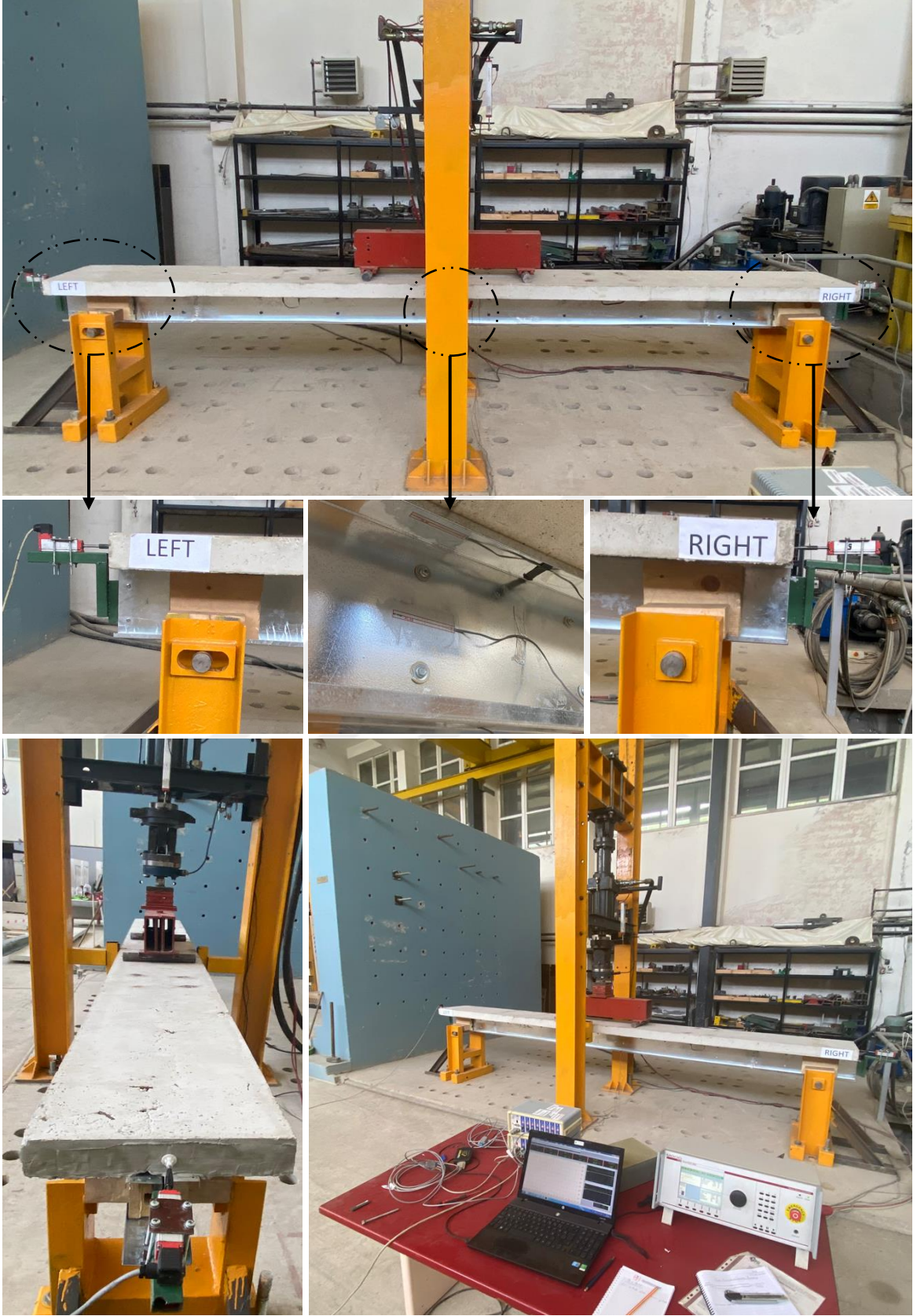
Şekil 45. Eğilme deney düzeneğinin detaylı görünümü
