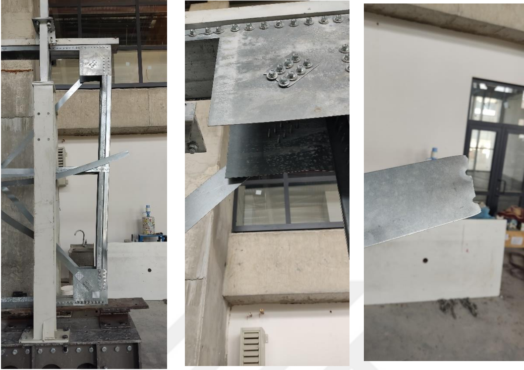
Şekil 5.41. W1 deney elemanı şerit çaprazın kopması
