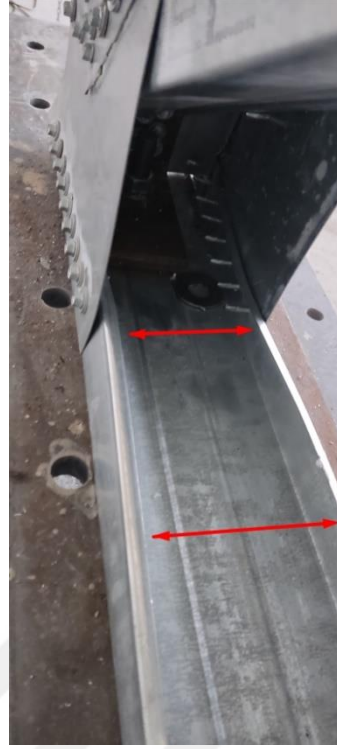
Şekil 5.73. W5 deney elemanı alt başlıklarda deformasyonlar.
