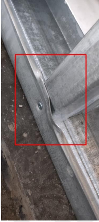
Şekil 5.73. W5 deney elemanı alt başlıklarda deformasyonlar.
