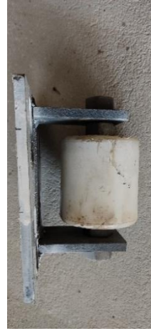
Şekil 5.10. Poliamid transpalet tekerleği.
