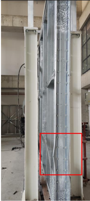
Şekil 5.49. W2 deney elemanı kenar dikmelerde burkulma hasarı.
