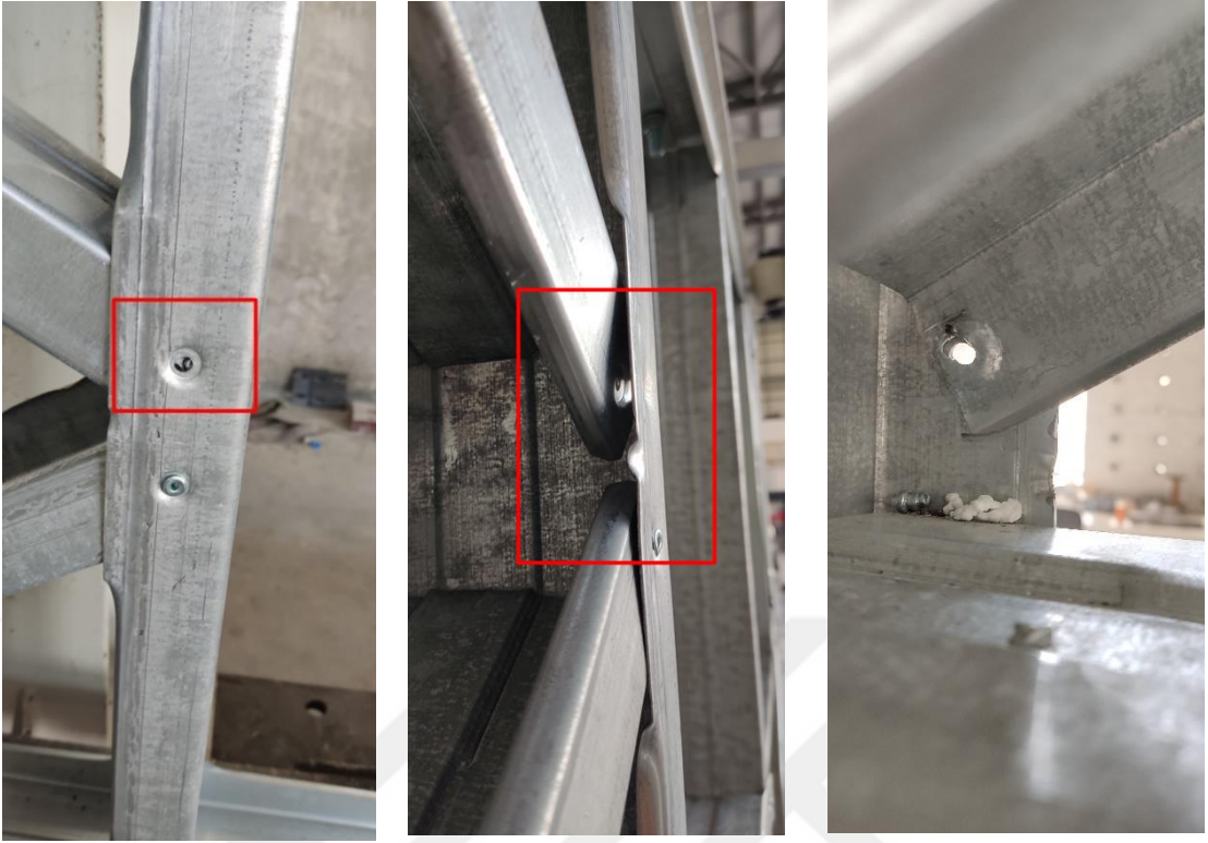
Şekil 5.65. W4 deney elemanı perçin atması.
