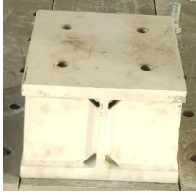
Şekil 5.7. HEA300'den teşkil mesnet elemanı.
