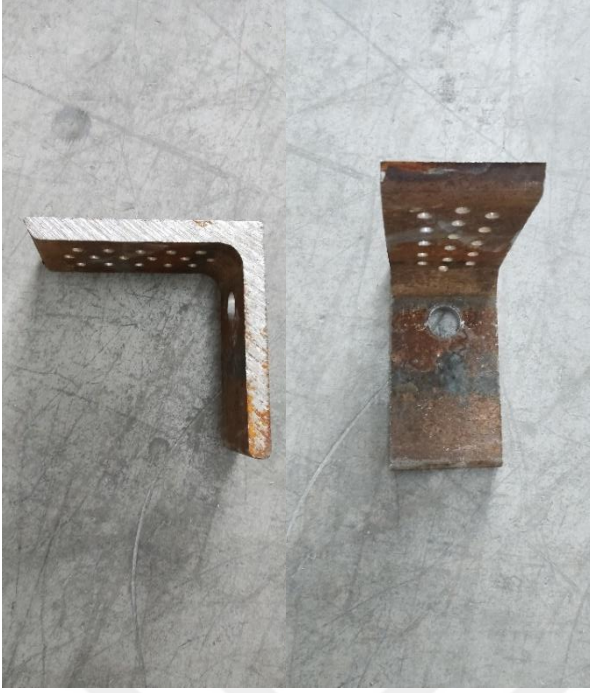
Şekil 5.16. L150x150x15 köşebentden teşkil mesnet elemanı.
