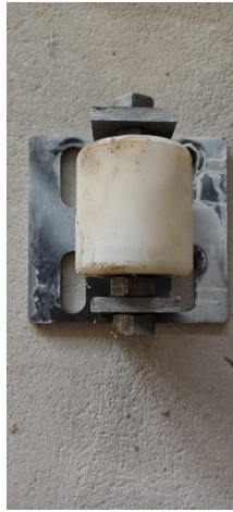
Şekil 5.10. Poliamid transpalet tekerleği.
