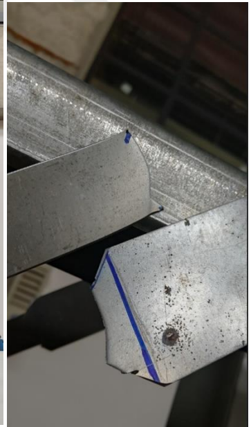
Şekil 5.74. W5 deney elemanı şerit çaprazın kopması.
