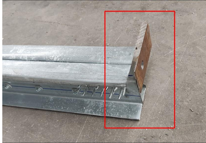
Şekil 5.17. Mesnet elemanının kenar dikmelere vidalanması.
