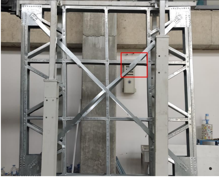
Şekil 5.74. W5 deney elemanı şerit çaprazın kopması.
