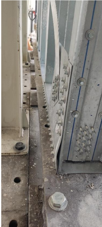
Şekil 5.38. W1 deney elemanı çaprazlarda burkulma ve guse plaka deformasyonu
