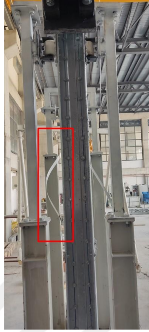
Şekil 5.39. W1 deney elemanı orta kuşakta deformasyon ve çapraz burkulması
