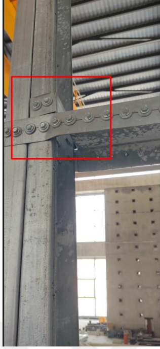
Şekil 5.39. W1 deney elemanı orta kuşakta deformasyon ve çapraz burkulması
