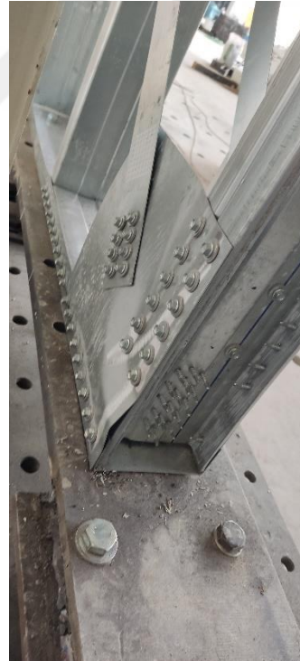
Şekil 5.38. W1 deney elemanı çaprazlarda burkulma ve guse plaka deformasyonu
