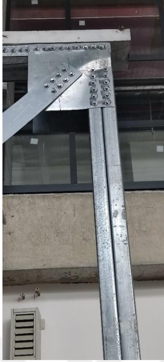
Şekil 5.48. W2 deney elemanı guse plakalarında oluşan deformasyon.
