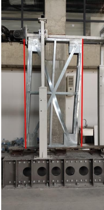
Şekil 5.58. W3 deney elemanı kenar dikmelerde burkulma hasarı.
