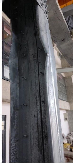
Şekil 5.58. W3 deney elemanı kenar dikmelerde burkulma hasarı.
