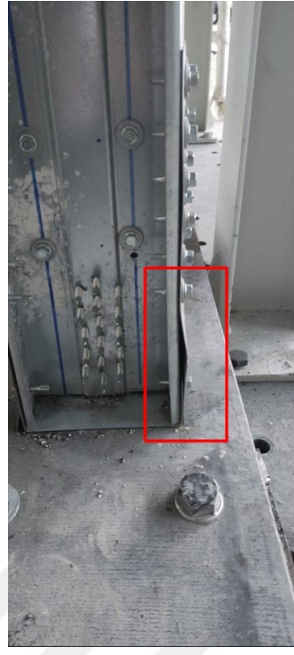
Şekil 5.48. W2 deney elemanı guse plakalarında oluşan deformasyon.
