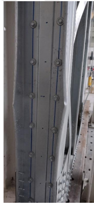
Şekil 5.58. W3 deney elemanı kenar dikmelerde burkulma hasarı.
