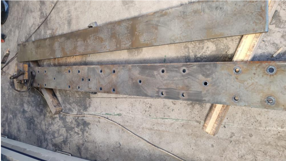
Şekil 5.8. Alt başlık mesnet elemanı.
