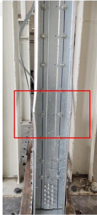
Şekil 5.40. W1 deney elemanı kenar dikmelerde burkulma
