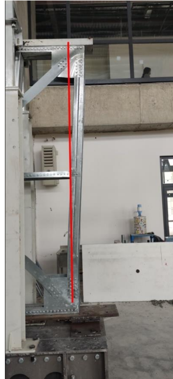
Şekil 5.49. W2 deney elemanı kenar dikmelerde burkulma hasarı.
