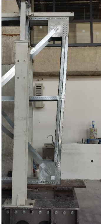
Şekil 5.40. W1 deney elemanı kenar dikmelerde burkulma
