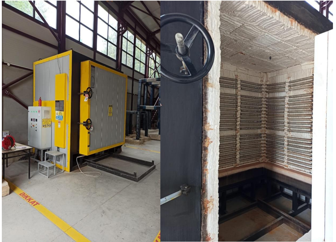
Şekil 3.4. Yangın fırınının iç ve dış görüntüsü
