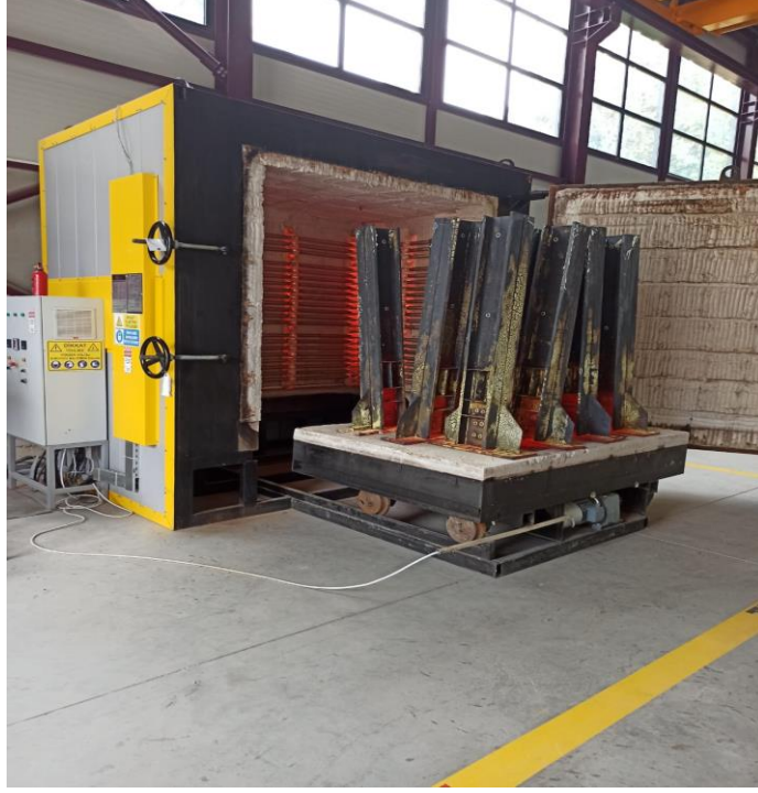
Şekil 3.13. Fırından çıkarılan kiriş numuneleri
