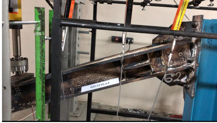
Şekil 4.24.G22-C2-P1,5-S Deneyi göçme modu
