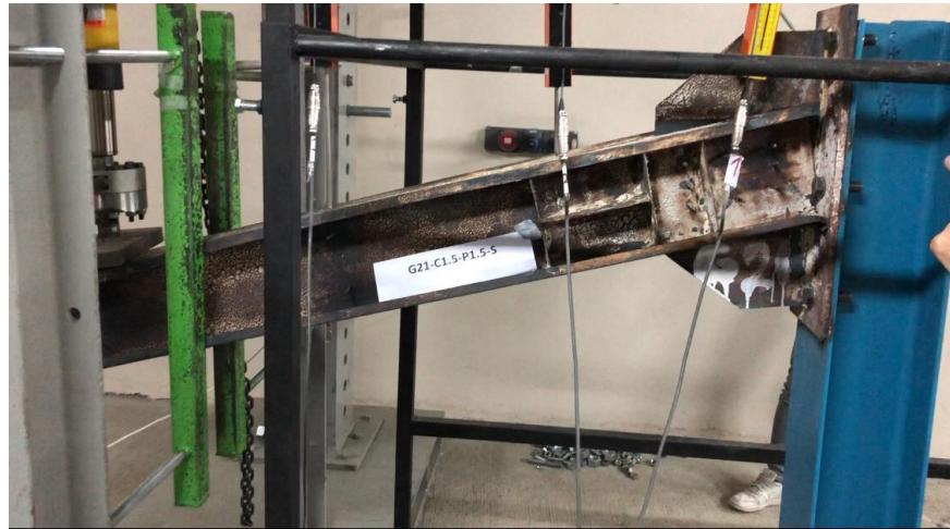
Şekil 4.23. G21-C1,5-P1,5-S Deneyi göçme modu
