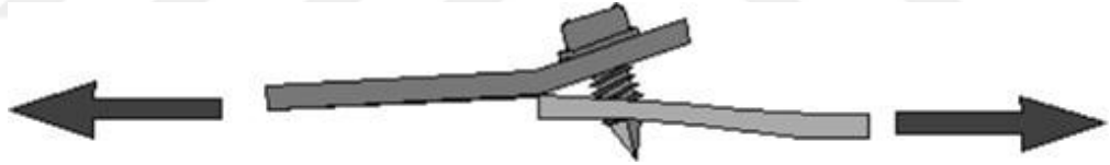
Şekil 2.10.Eğilme ve sıyrılma göçme modu (TC 7 - TWG 7.10 , 2009)
