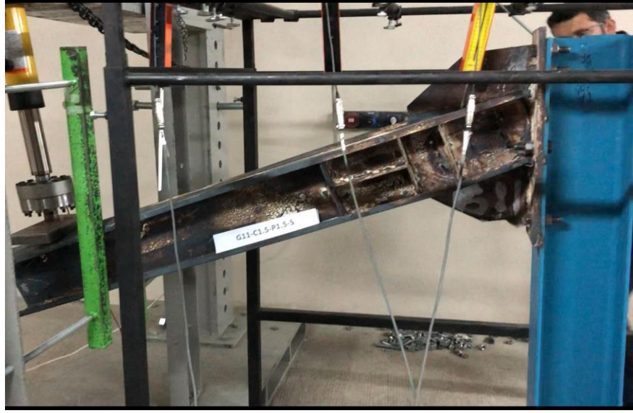
Şekil 4.7. G11-C1.5-P1.5-S Deneyi göçme modu
