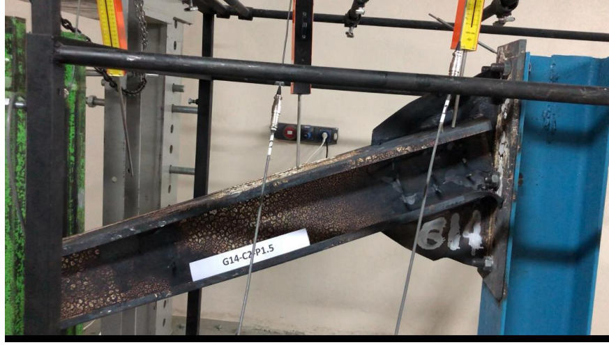
Şekil 4.10.G14-C2-P1,5 Deneyi göçme modu
