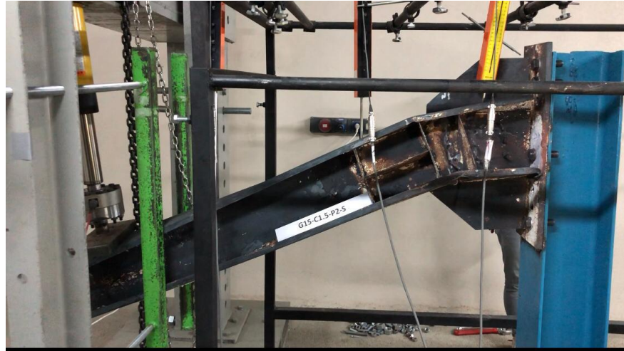
Şekil 4.15.G15-C1,5-P2-S Deneyi göçme modu
