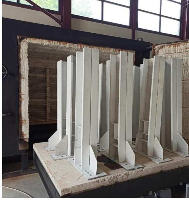
Şekil 3.10. Fırına atılmak üzere intümesan boya kaplanan kiriş numuneleri
