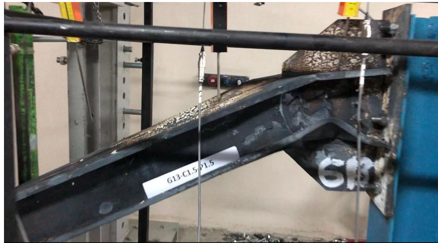
Şekil 4.9. G13-C1.5-P1.5 Deneyi göçme modu
