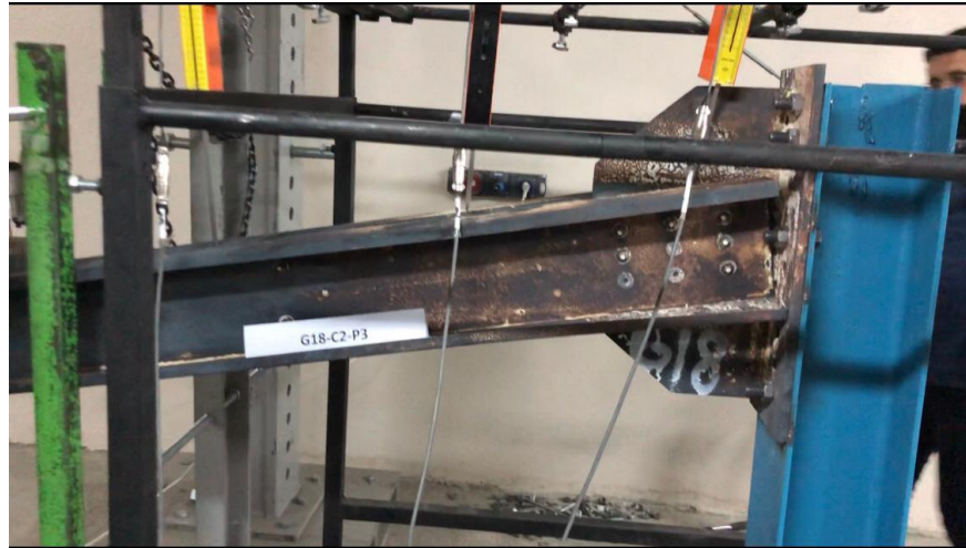
Şekil 4.19. G18-C2-P3 Deneyi göçme modu
