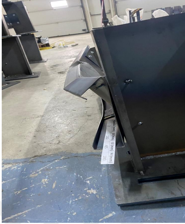
Şekil 4.70. Deneylerde kiriş burkulması ve köşebent akıllı vida sıyırması durumu
