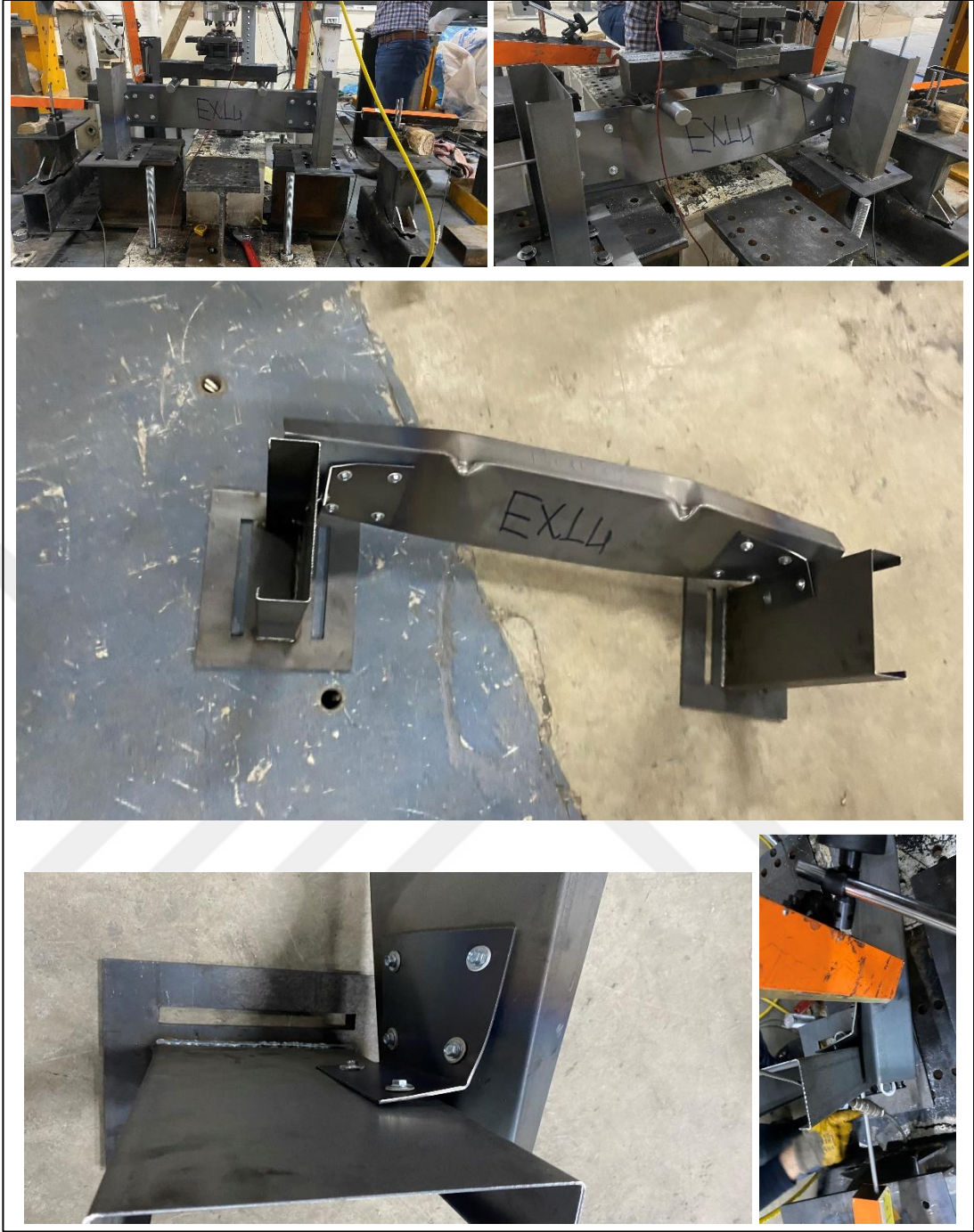
Şekil 4.42. EXP14-2,5-65-150 deney sonrası göçme görselleri
