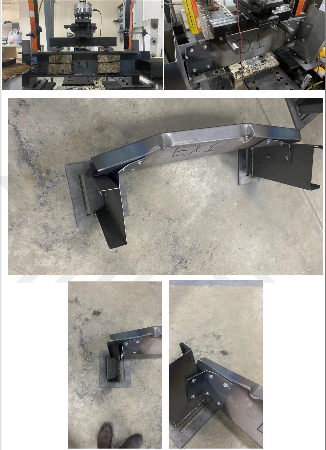
Şekil 4.47. EXP1-2,5-95-180 deney sonrası göçme görselleri
