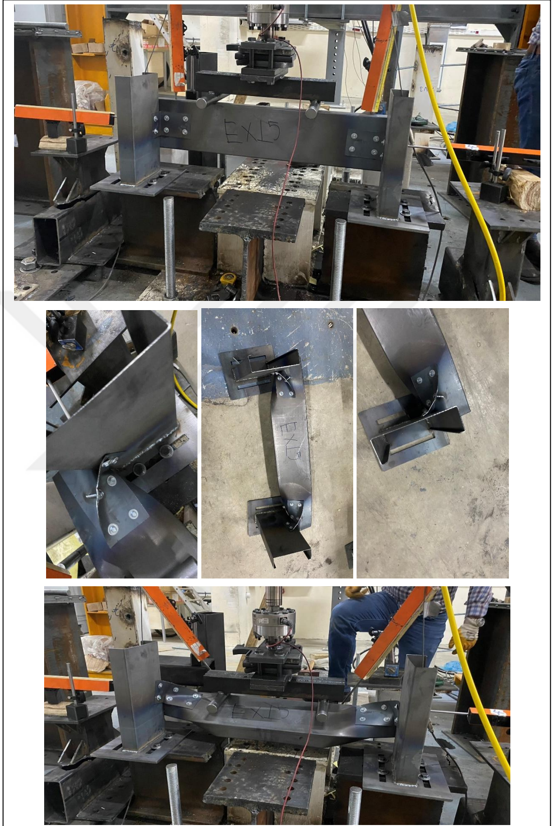
Şekil 4.14. EXP15-1,5-65-100 deney sonrası göçme görselleri
