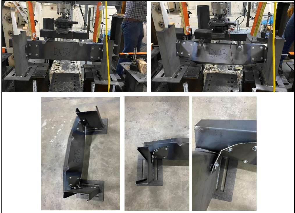
Şekil 4.30. EXP33-2-65-150 deney sonrası göçme görselleri
