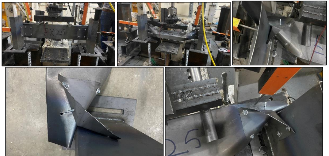
Şekil 4.7. EXP25-1,2-95-150 deney sonrası göçme görselleri
