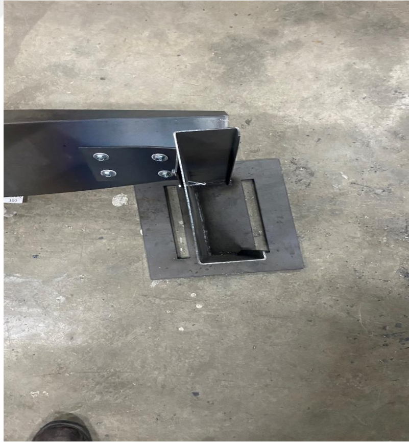
Şekil 4.71. Kolon burulmalı burkulma durumu
