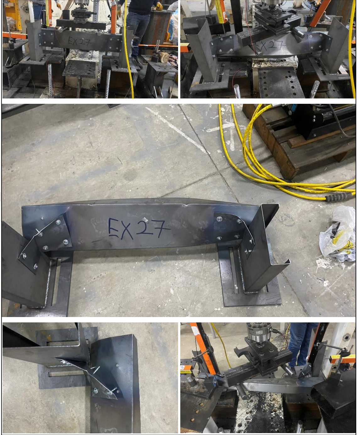
Şekil 4.19. EXP27-1,5-95-150 deney sonrası göçme görselleri
