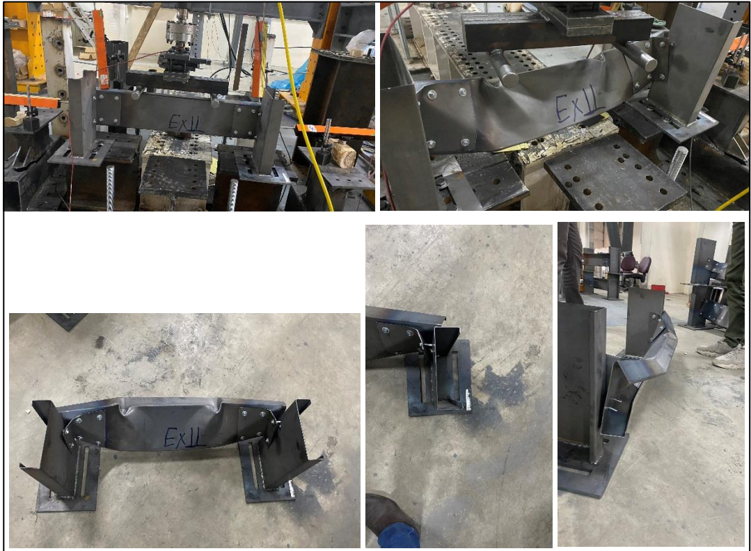
Şekil 4.34. EXP11-2-65-180 deney sonrası göçme görselleri
