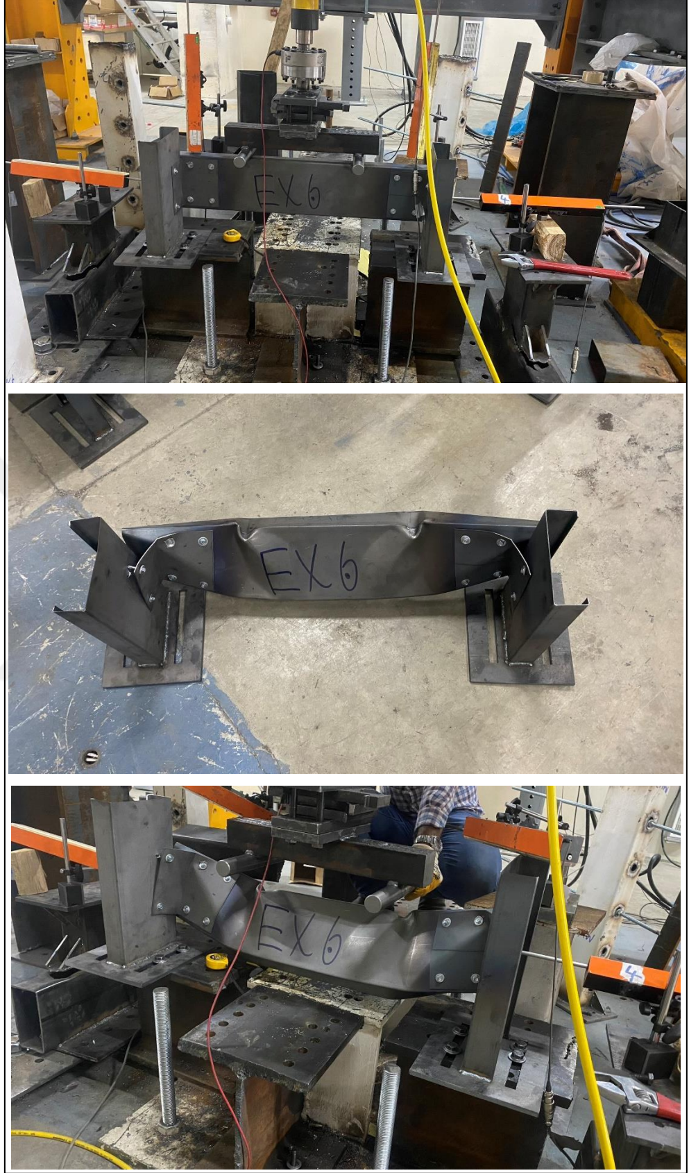
Şekil 4.35. EXP6-2-95-180 deney sonrası göçme görselleri
