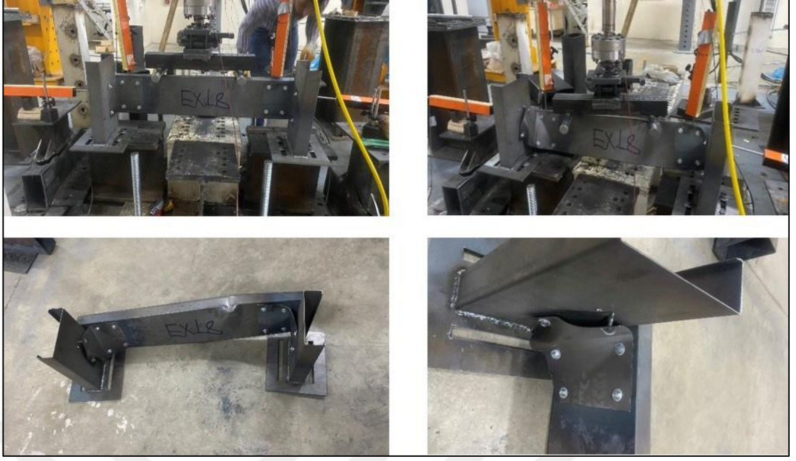
Şekil 4.12. EXP18-1,2-65-100 deney sonrası göçme görselleri
