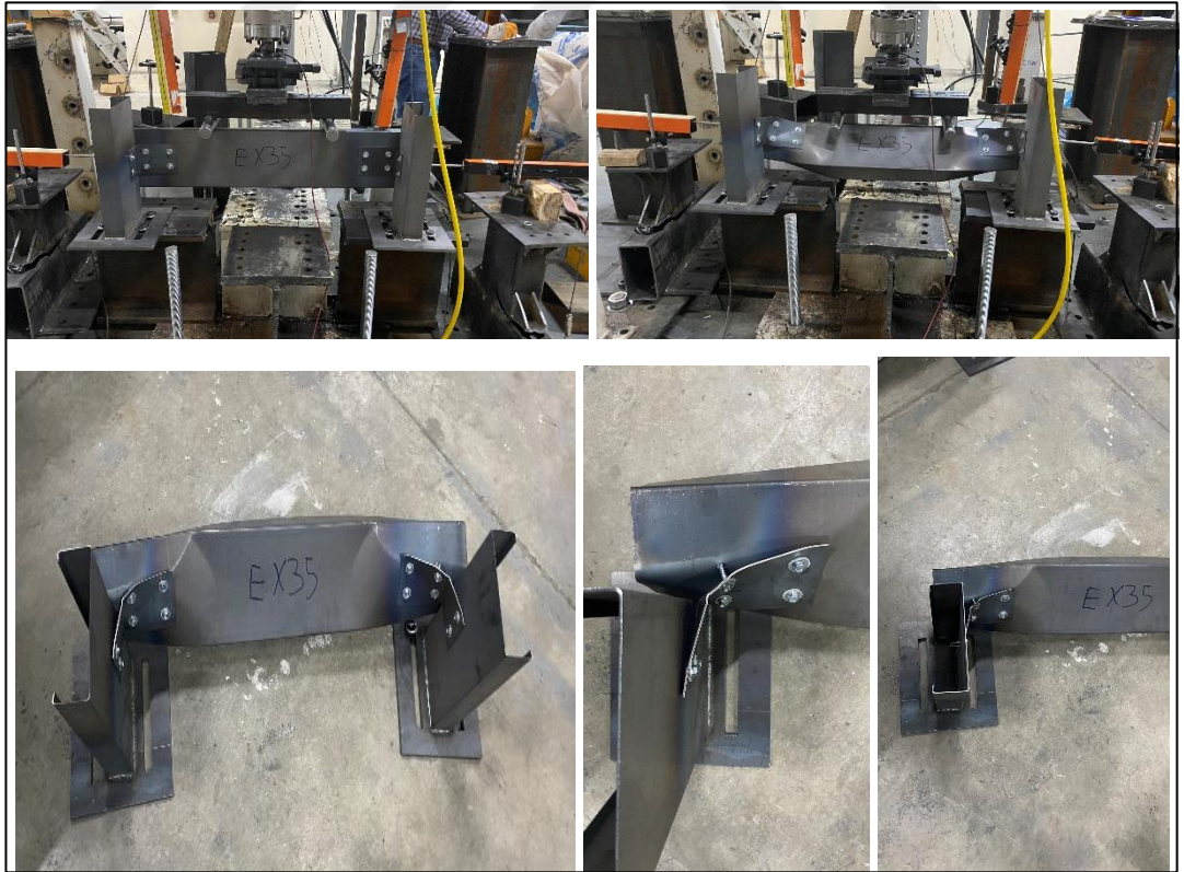
Şekil 4.27. EXP35-2-95-100 deney sonrası göçme görselleri
