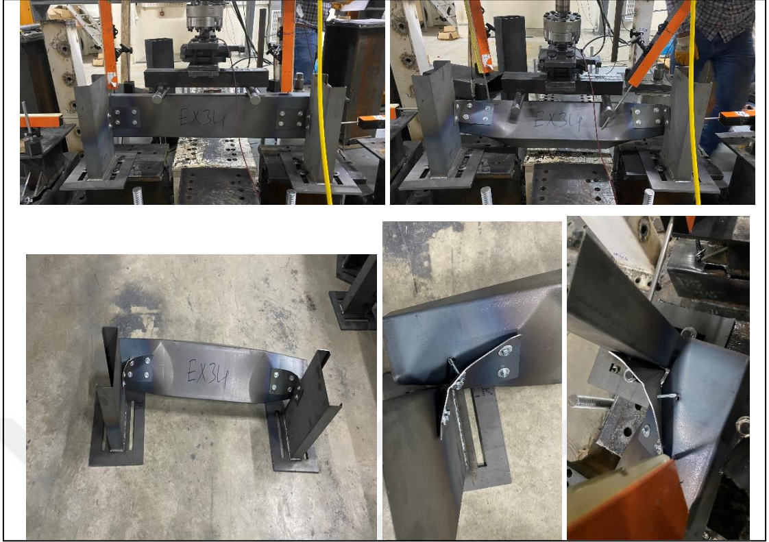
Şekil 4.26. EXP34-2 -65-100 deney sonrası göçme görselleri
