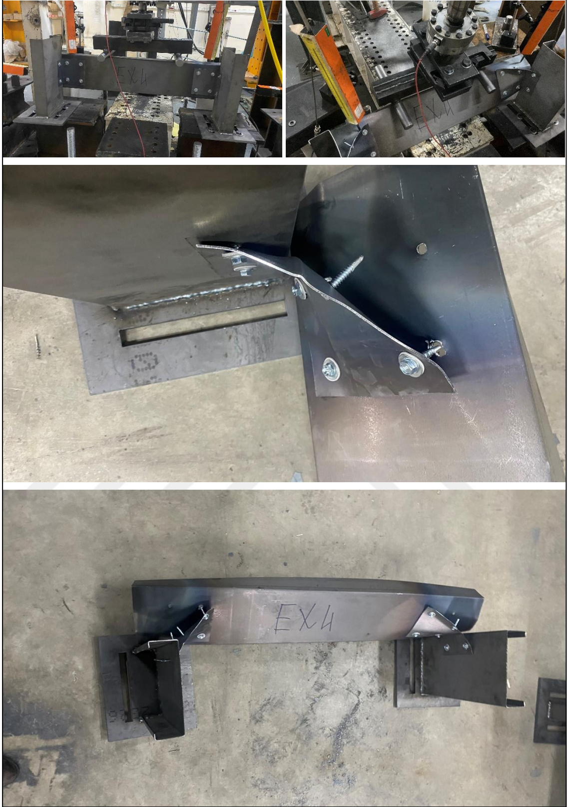
Şekil 4.18. EXP4-1,5-65-150 deney sonrası göçme görselleri
