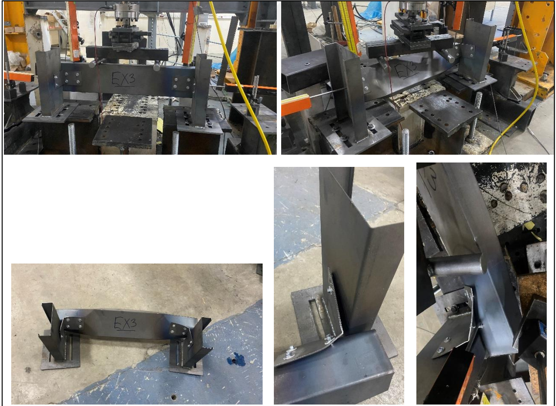
Şekil 4.40. EXP3-2,5-125-100 deney sonrası göçme görselleri
