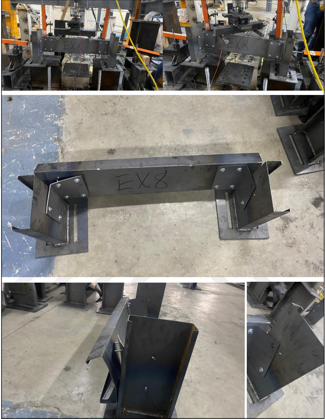
Şekil 4.48. EXP8-2,5-125-180 deney sonrası göçme görselleri
