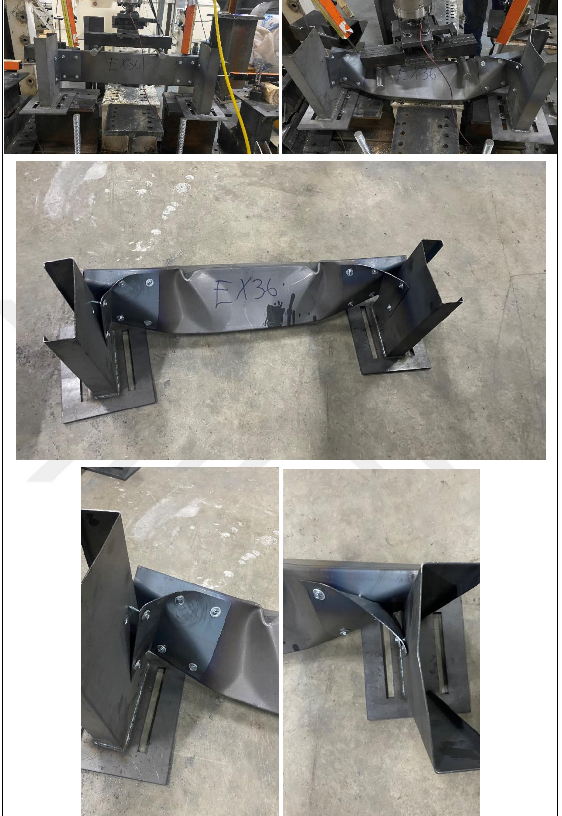
Şekil 4.23. EXP36-1,5-95-180 deney sonrası göçme görselleri
