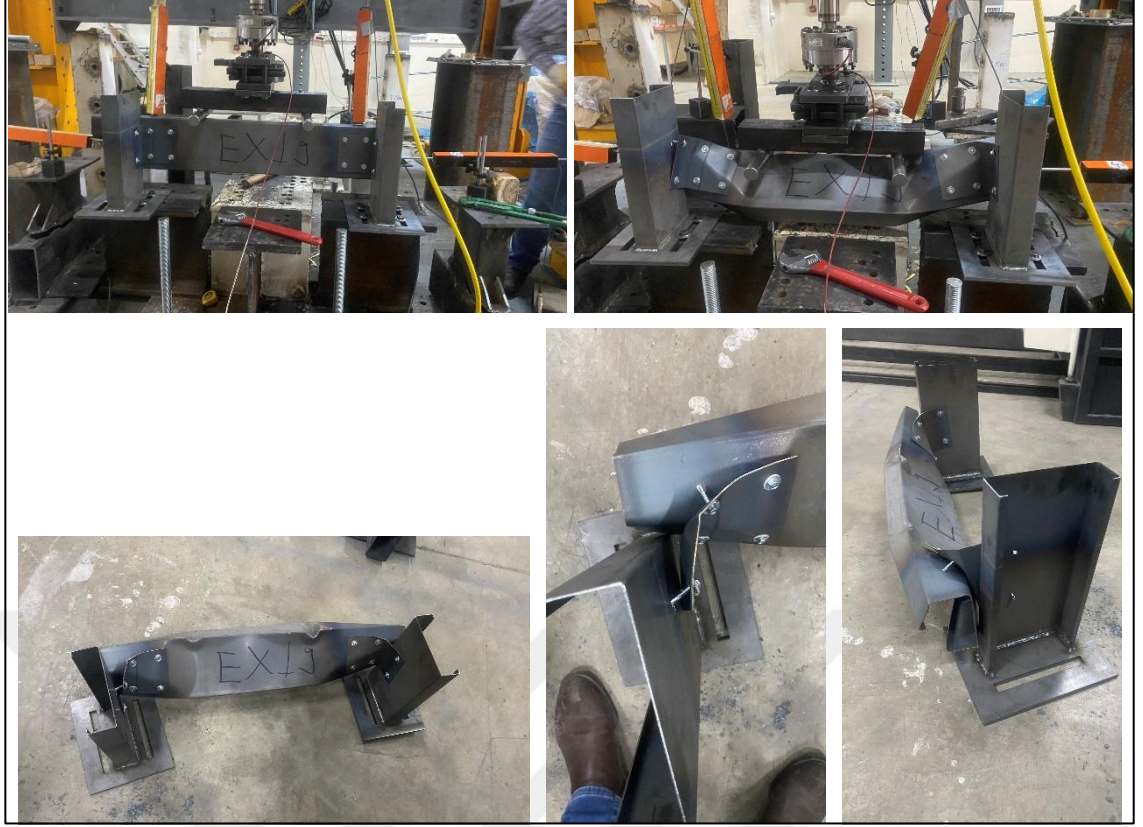
Şekil 4.31. EXP19-2-95-150 deney sonrası göçme görselleri
