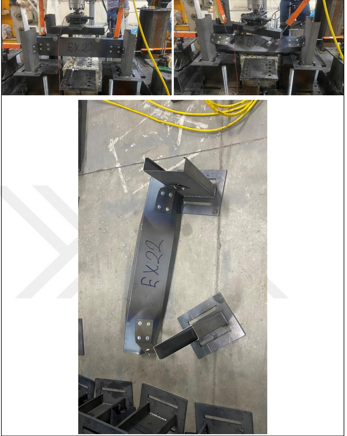
Şekil 4.28. EXP22-2-125-100 deney sonrası göçme görselleri
