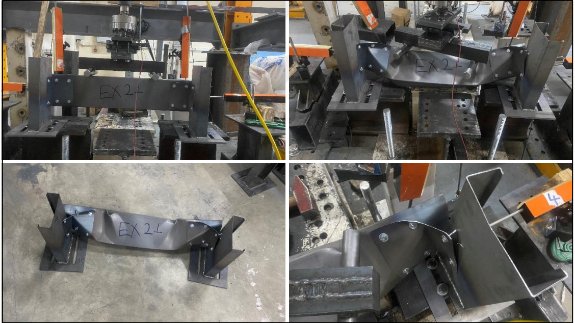
Şekil 4.11. EXP21-1,2-95-180 deney sonrası göçme modları
