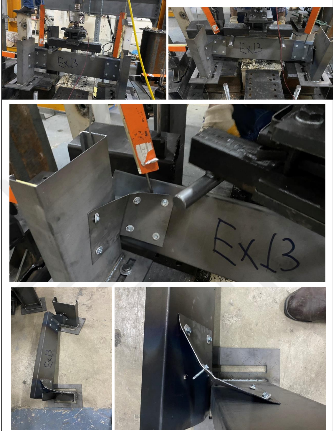
Şekil 4.20. EXP13-1,5-125-150 deney sonrası göçme görselleri
