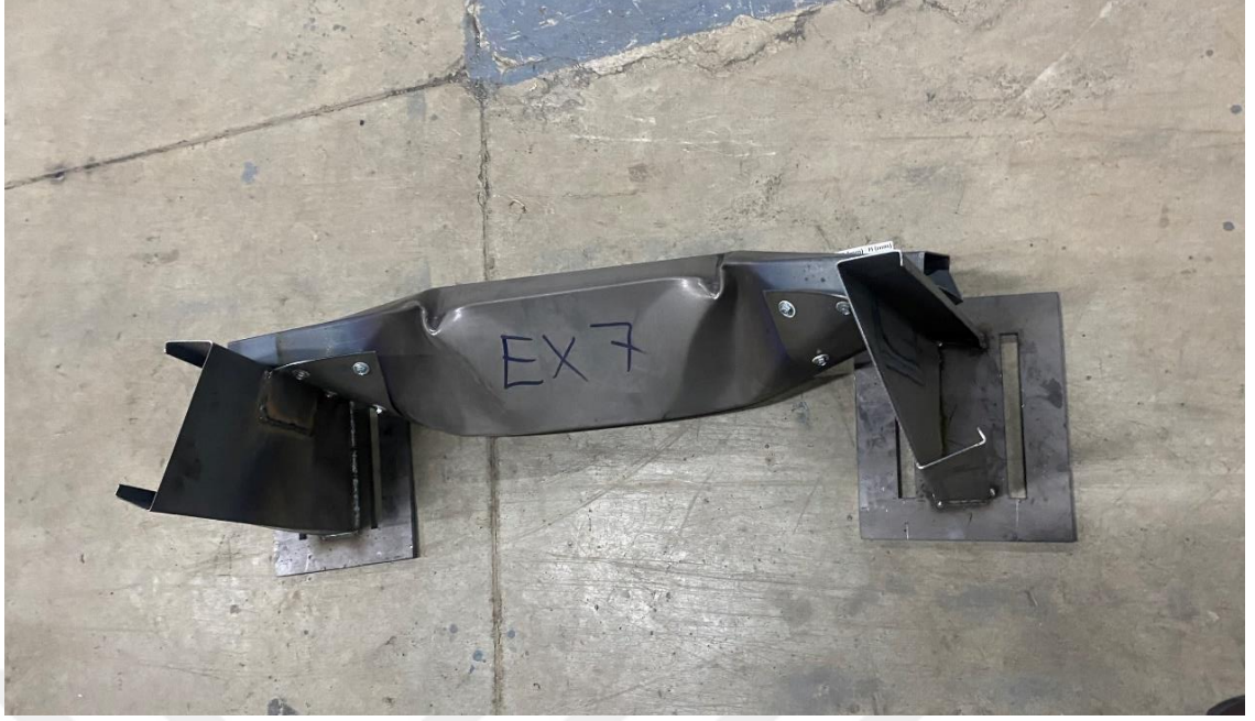
Şekil 4.76. Kolon burulmalı burkulması ve kiriş burkulması durumu (Yavuz 2023)
