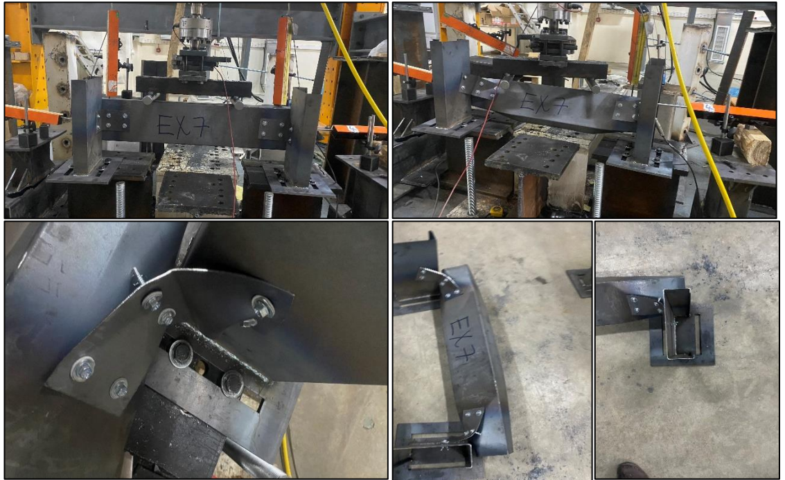
Şekil 4.3. EXP7-1,2-95-100 deney sonrası göçme görselleri
