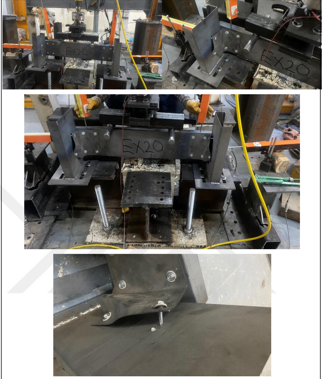
Şekil 4.24. EXP20-1,5-125-180 deney sonrası göçme görselleri
