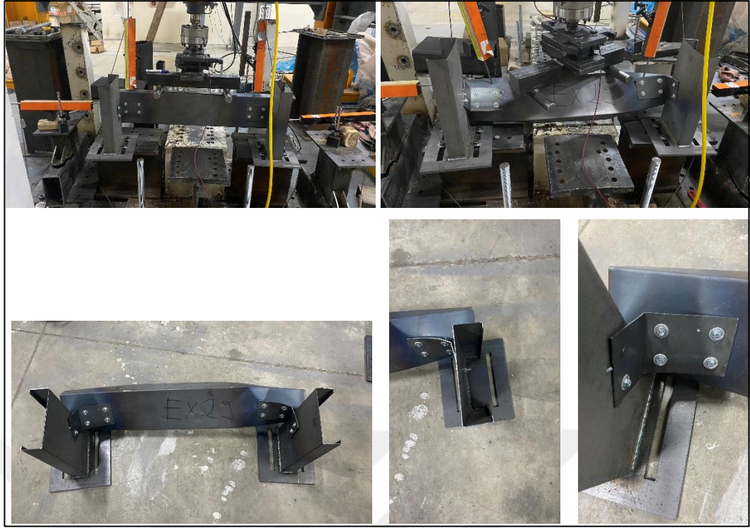
Şekil 4.39. EXP29-2,5-95-100 deney sonrası göçme görselleri
