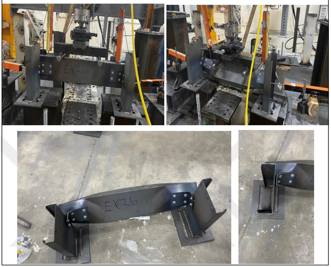
Şekil 4.38. EXP26-2,5-65-100 deney sonrası göçme görselleri
