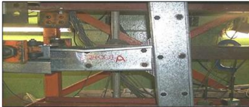
Şekil 1.3. Kolon-kiriş birleşim deney sonucu yanal göçmesi (Yu vd. 2005)
