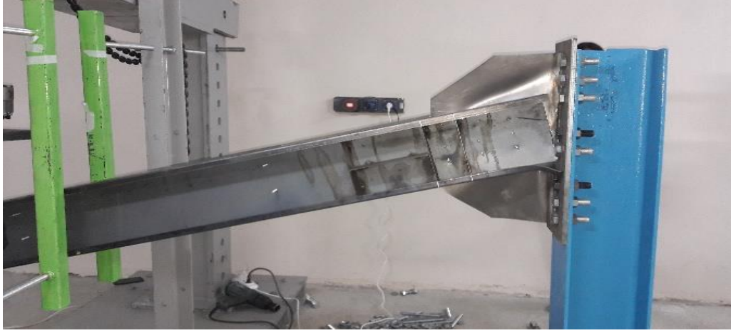
Şekil 4.14. T3-C2-P1-S kirişinin göçme modu
