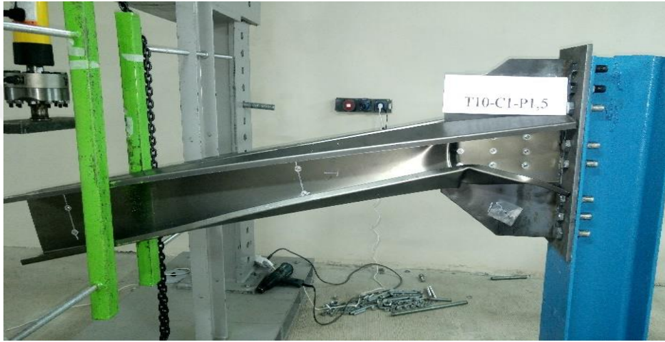
Şekil 4.33. T10-C1-P1.5 kirişinin göçme modu
