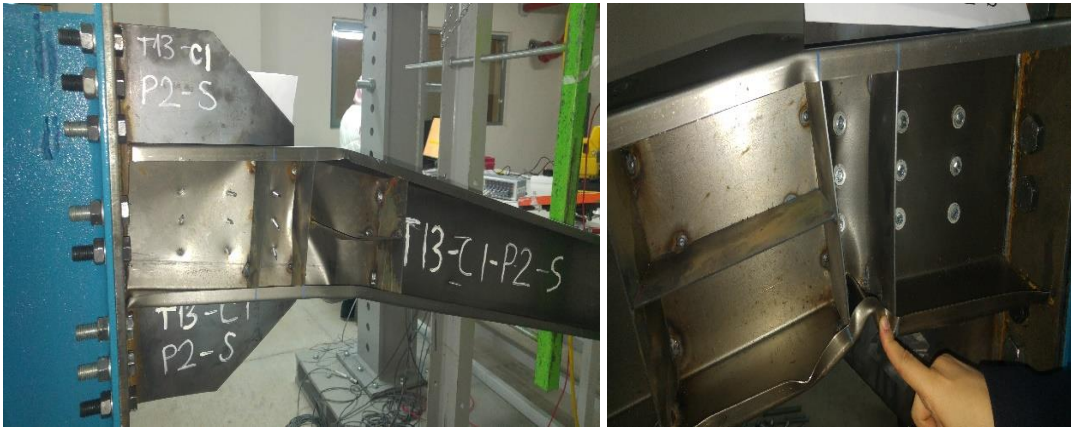
Şekil 4.41. T13-C1-P2-S kirişinin göçme modu
