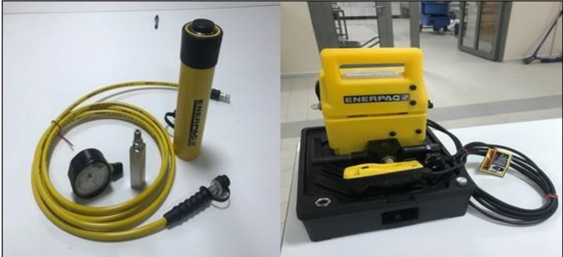
Şekil 3.4. Hidrolik pompa ve piston
