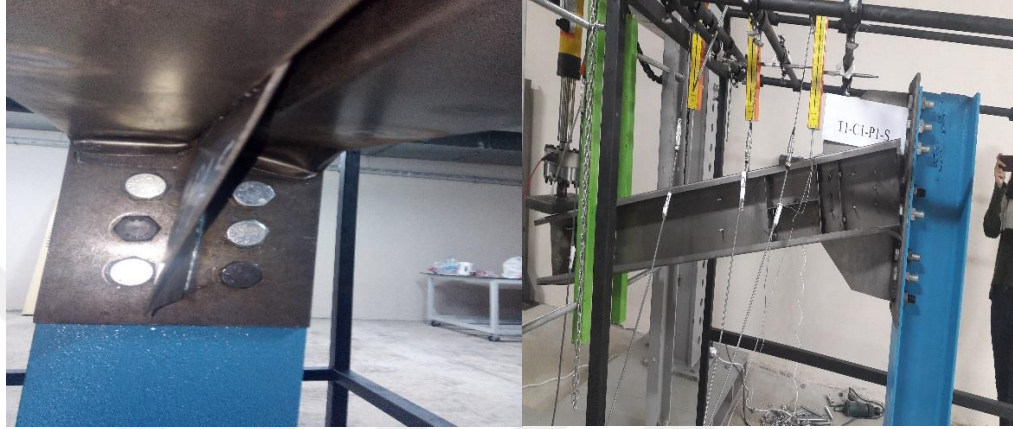
Şekil 4.12. T1-C1-P1-S kirişinin göçme modu
