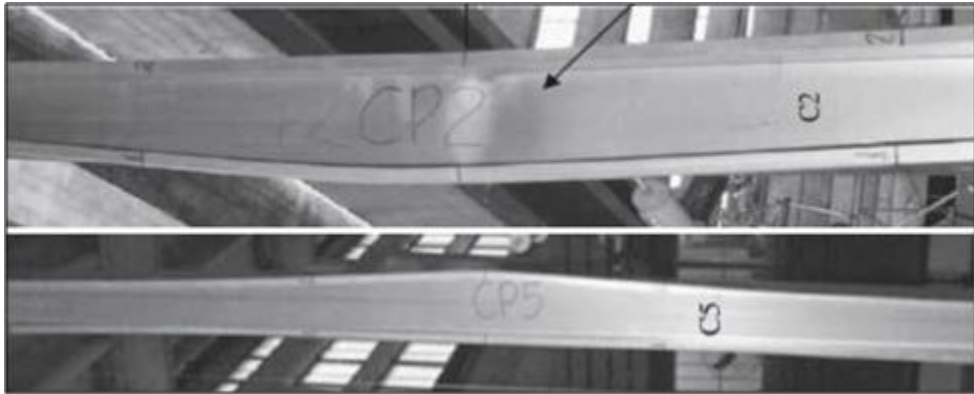
Şekil 1.1. Yerel, çarpılmalı ve genel burkulma modları (Santos vd. 2012)
