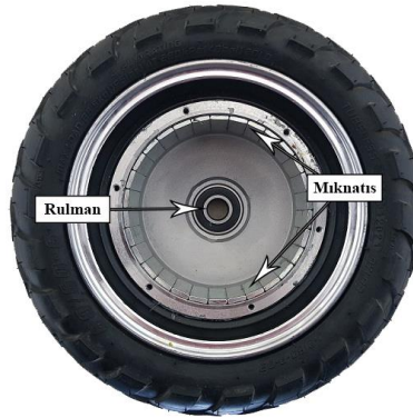
Şekil 2.5. HEA BLDC'nin Hub rotor yapısı
