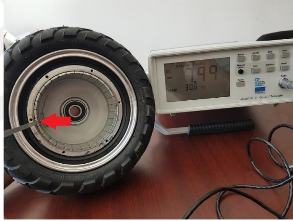
Şekil 3.9. Mıknatıs arızası oluşturulduktan sonra yapılan ölçüm
