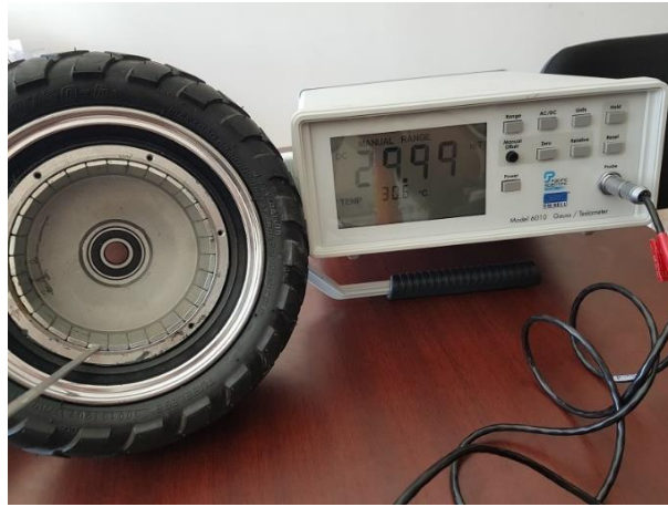
Şekil 3.10. Sağlam mıknatıs ölçüm değeri
