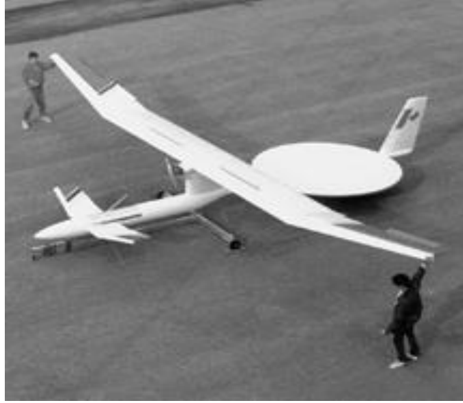
Şekil 1.8. SHARP firmasının mikrodalga enerjisi ile çalışan uçağı [43].
