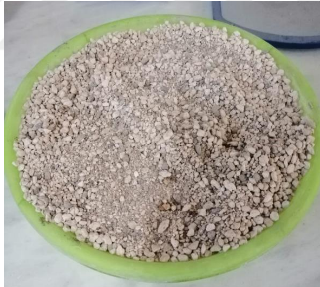
Şekil 1.4. Beyaz renkli inşaat pomzası
