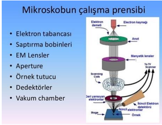
Şekil 2.4. Taramalı elektron mikroskobu şematik görünüm
