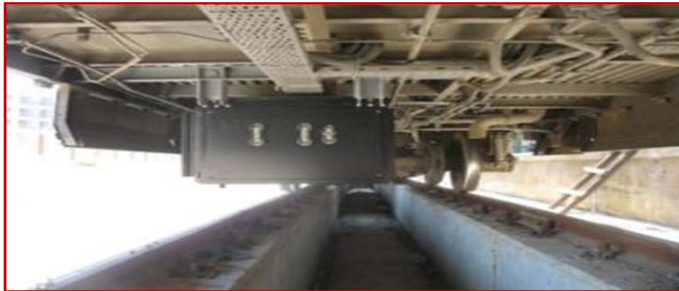
Şekil 2.4 Statik konvertör ünitesinin tren üzerine montaj yeri.
