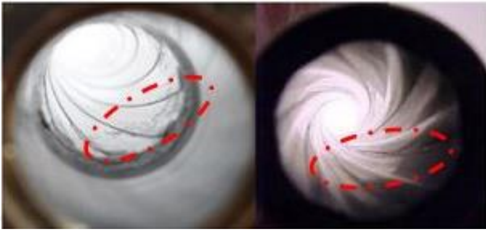
Şekil 2.8. Konvansiyonel ve poligonal namlularındaki barut artığı görünümü
