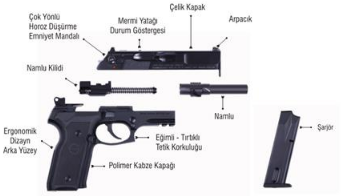
Şekil 2.3. Tabancanın patlatılmış görüntüsü
