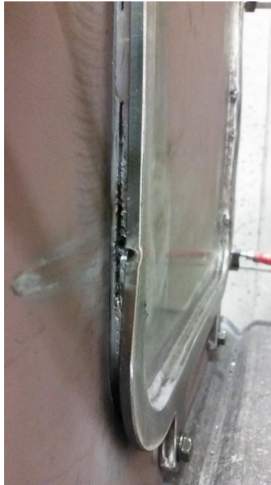
Şekil 7.2. 7.62x51 (AP) mermisinin 8mm zırh boşluğu olan gömme tipi numuneye 15 derece atış açısıyla atış yapıldıktan sonra mermi giriş hasarının gösterimi.
