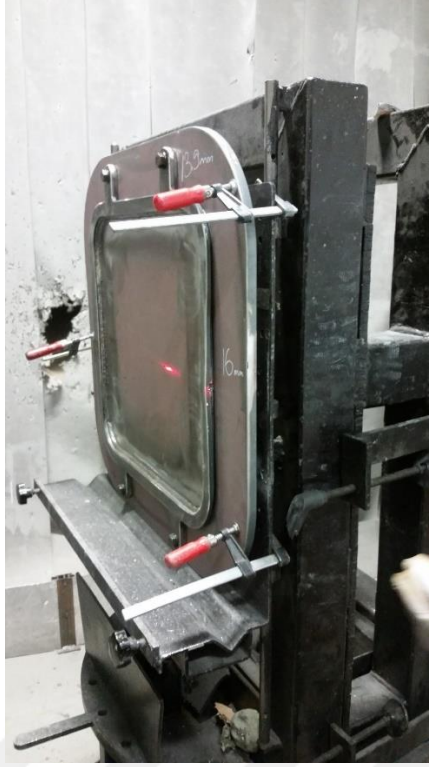
Şekil 7.1. 7.62x51 (AP) mermisinin 8mm zırh boşluğu olan gömme tipi numuneye 15 derece atış açısıyla mermi nişangahının yapılması.
