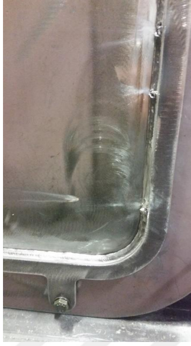
Şekil 7.3. 7.62x51 (AP) mermisinin 8mm zırh boşluğu olan gömme tipi numuneye 15 derece atış açısıyla atış yapıldıktan sonra mermi çıkış hasarının gösterimi.
