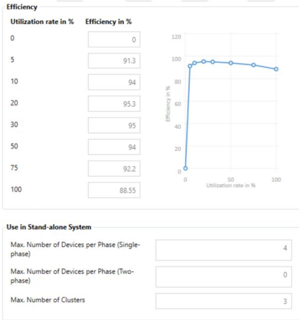
Şekil 4.66. Batarya evirici verimi ve şebekeden bağımsız kullanım verileri
