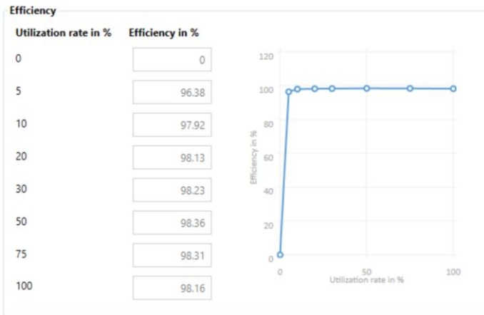
Şekil 4.52.15 kW evirici verim değerleri
