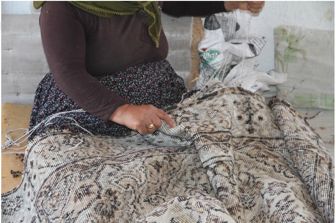
Fotoğraf 35 - Halının Kenar İşlemlerinde Sarkan Atkı İpliklerinin Alınması
