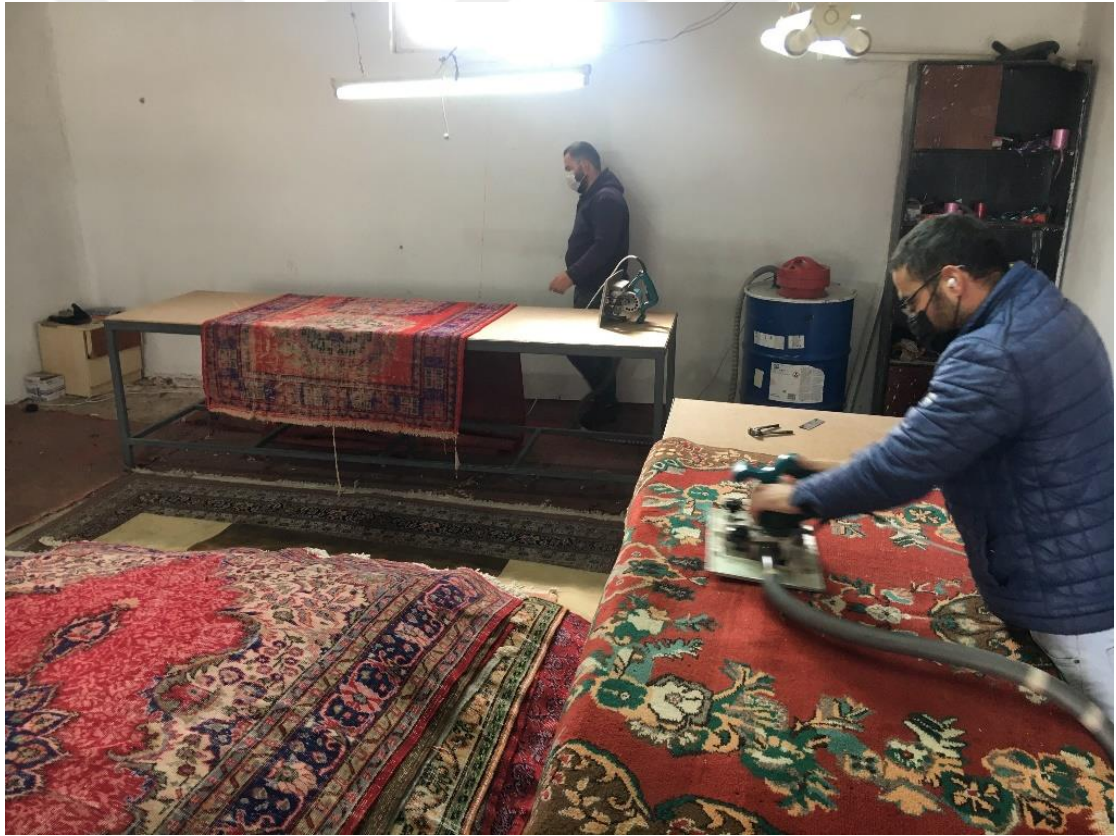
Fotoğraf 27 - Masaüstü Silindir Bıçaklı Tıraş Makinesiyle Havların Kısaltılması
