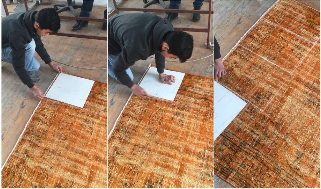
Fotoğraf 37 - Patchwork Halıda Kullanılmak Üzere Tebeşirle Çizilerek Kalıp Çıkarılması
