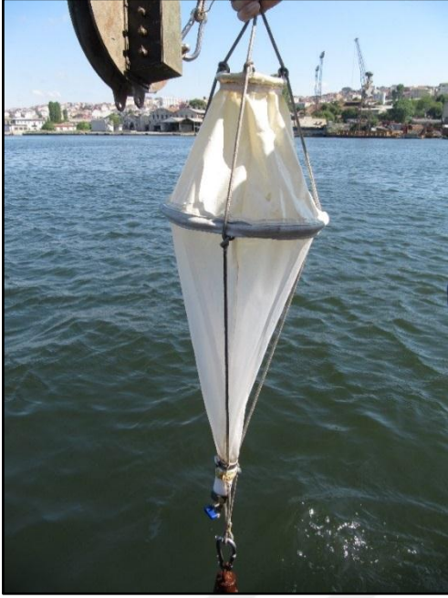
Şekil 2. Apstein tipi plankton kepçesi
