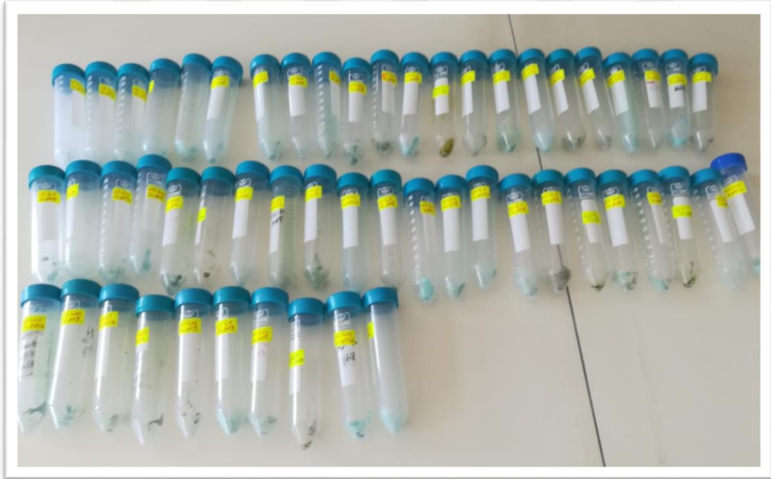
Resim 3.8. Sentez reaksiyonlarının sonucunda elde edilmiş olan mavi renkli bakır ( \text{Cu}^{2+} ) hibrit nanoçiçekler ve gri/beyaz renkli çinko ( \text{Zn}^{2+} ) hibrit nanoçiçeklere ait örnekler (Fotoğraflar Emrah BOR tarafından çekilmiştir.)
