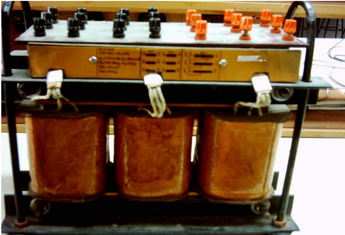
Tasarımlanan diferansiyel röle ile koruması yapılan 2 kVA380/110V Transformatör
