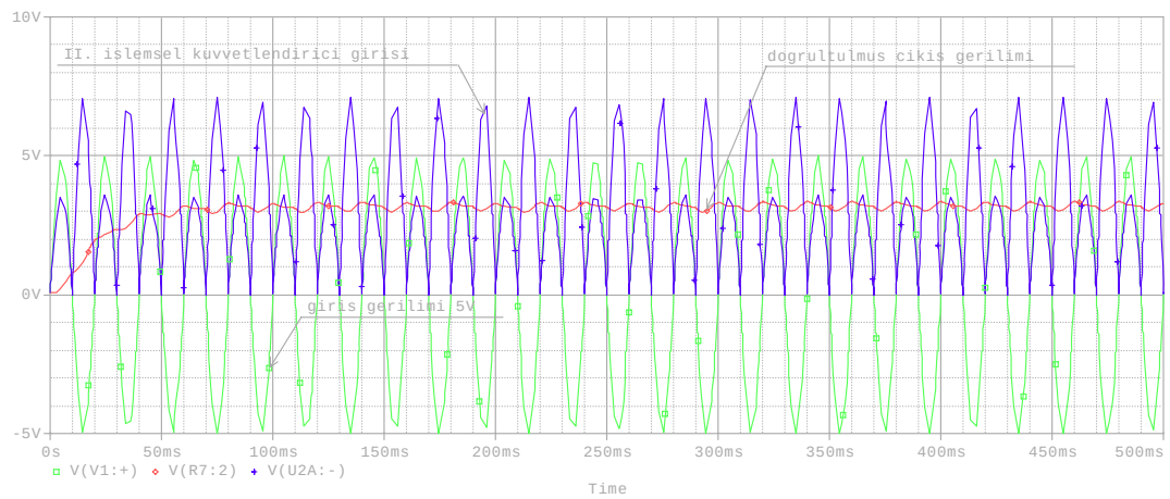
Şekil 5.2. İşlem kuvvetlendiricili doğrultucu devresi
