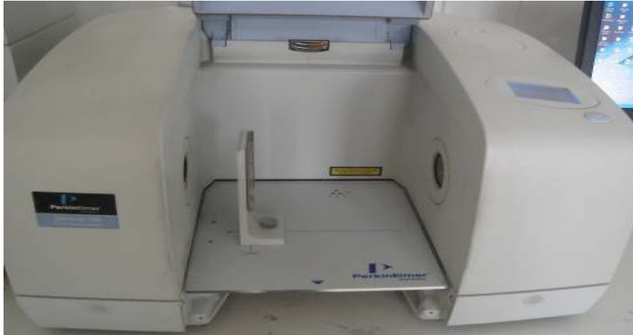
Şekil 1.3. FT-IR cihazında numune konulan kısım
