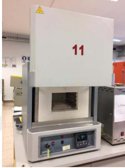
Görsel 9.3. Kalsinasyon işleminin yapıldığı kül fırını
