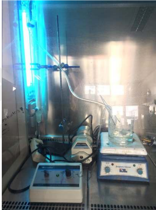
Görsel 9.15. Dalgulu reaktörde yarı sürekli akışta UV ışın ile arıtım
