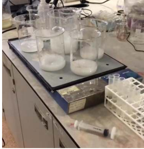
Görsel 9.12. Tam karıştırmalı reaktörde kesikli akışta arıtım
