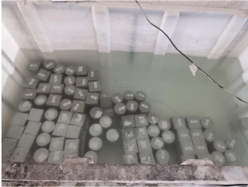
Şekil 10. Numunelerin kür havuzuna yerleştirilmesi
