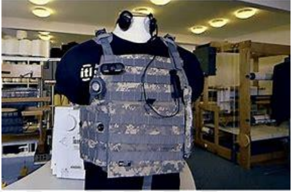
Şekil 3.7. Kurşunlardan kaynaklanan asker yaralanmalarının tespiti için tasarlanmış entegre elektrik iletken fiberler (Textile Details, 2023)
