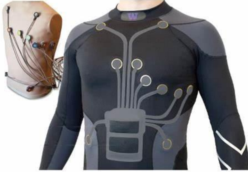
Şekil 3.8. GPS aracılığıyla sıcaklığı, kalp atış hızını ve konumu kontrol eden giyilebilir giysiler (Empowstudios, 2022)
