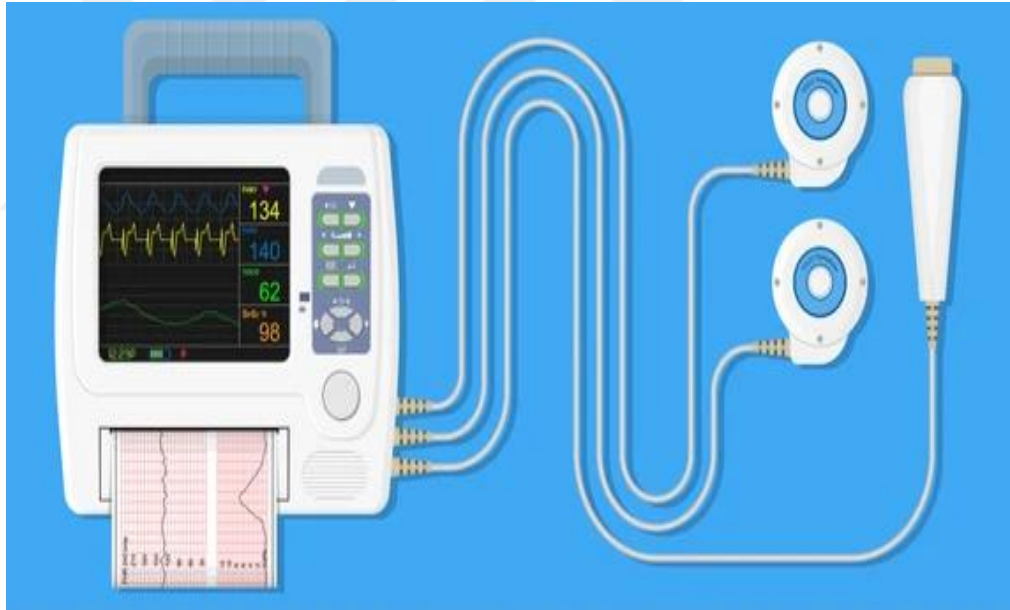
Şekil 1.5. Bir tokodinamometre basınç sensörü, bir ultrason dönüştürücü ve merkezi / baskı ünitesi içeren standart bir fetal izleme cihazı (HealthDay, 2022).
