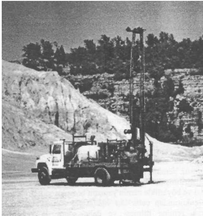
Şekil 3.2 Kamyon Üzerine Monte Edilmiş Sondaj Makinesi (Kanıt, 2003).
