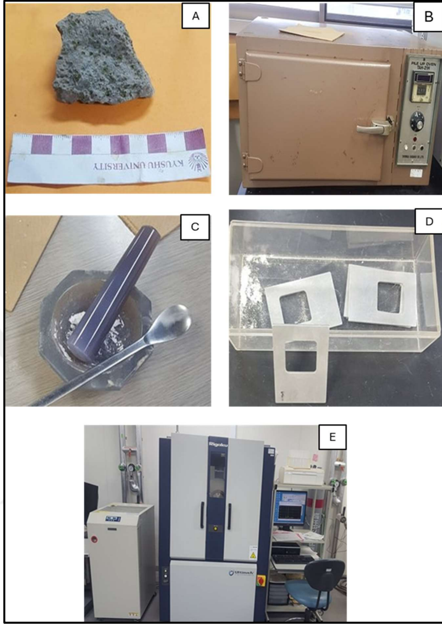
Şekil 3. 9. XRD için yığın numune hazırlama ve cihazlama (a) kaya örneği, (b) fırın, (c) havan ve tokmak, (d) metal plaka üzerinde sıkıştırılmış toz örneği, (e) Rigaku XRD makinesi.
