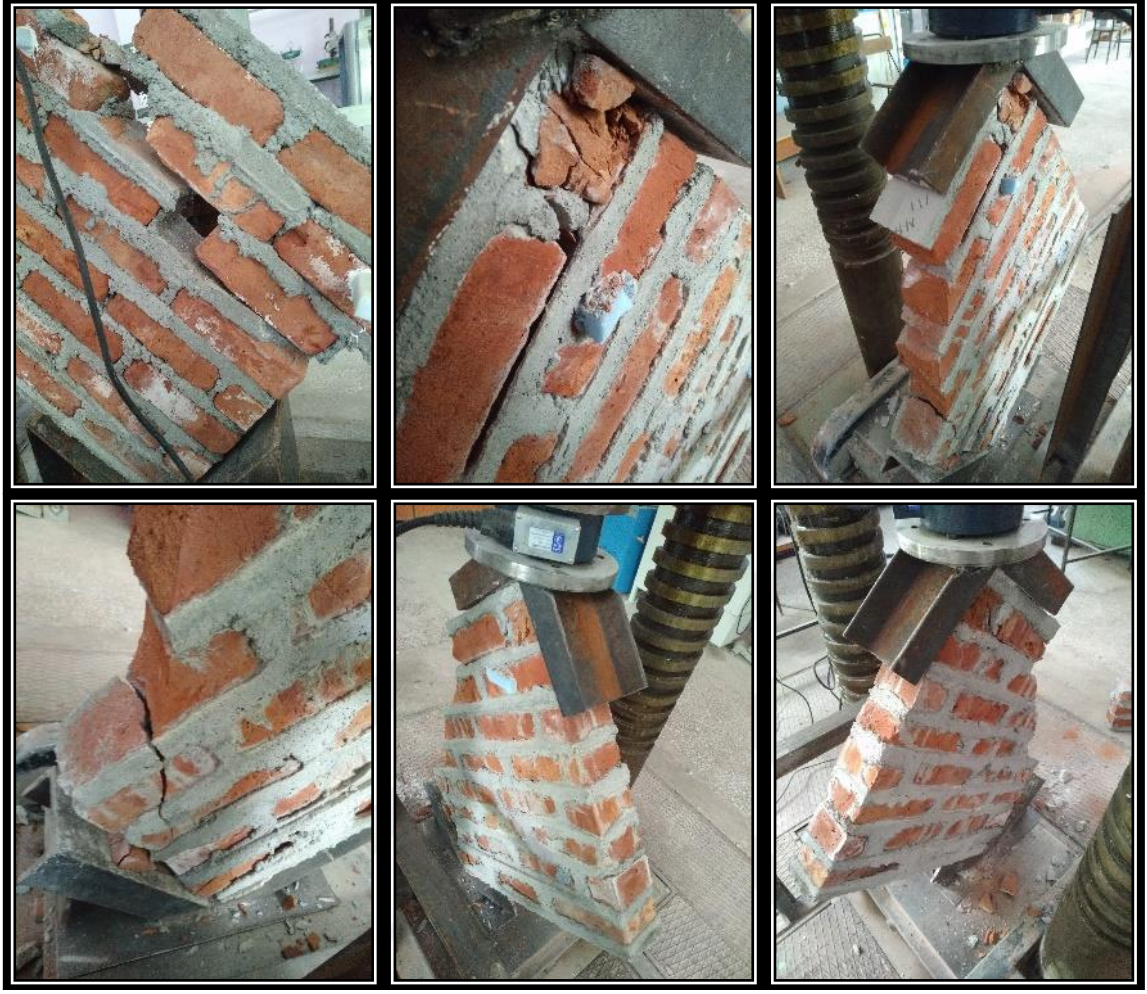
Şekil E1.24. D2NHO3 tip duvarlara ait hasar fotoğrafları
