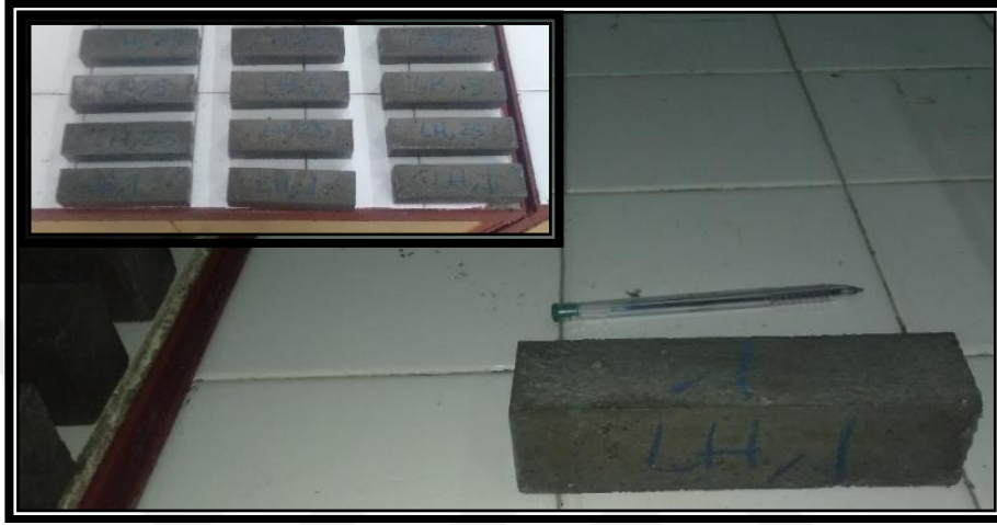
Şekil 6.11. 40×40×160 mm boyutlarında oluşturulan harç numuneleri
