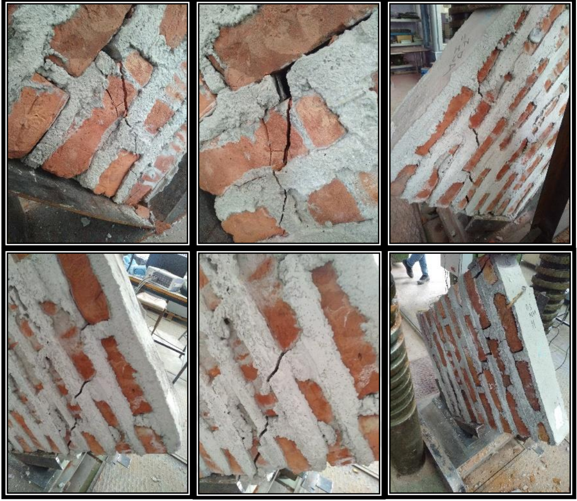
Şekil E1.35. D3NHO2 tip duvarlara ait hasar fotoğrafları
