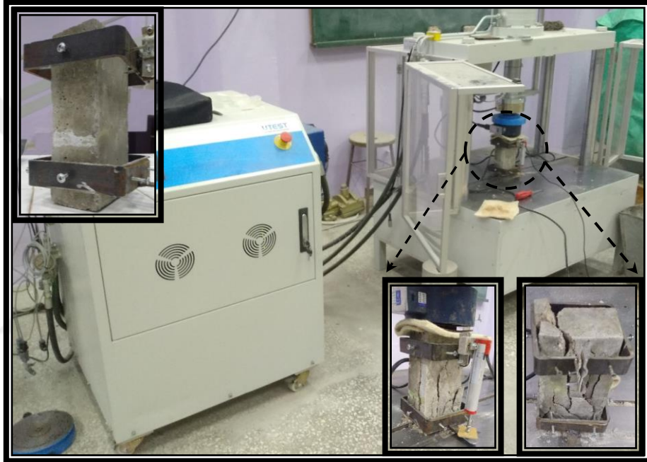
Şekil 6.13. Harç numunelerinin elastisite modüllerinin belirlenmesi
