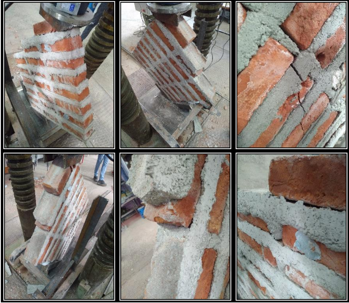
Şekil E1.31. D3L3O1 tip duvarlara ait hasar fotoğrafları
