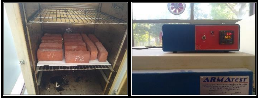
Şekil 6.4. Numunelerin 105 \pm 5 °C sıcaklıktaki etüvde kurutulması
