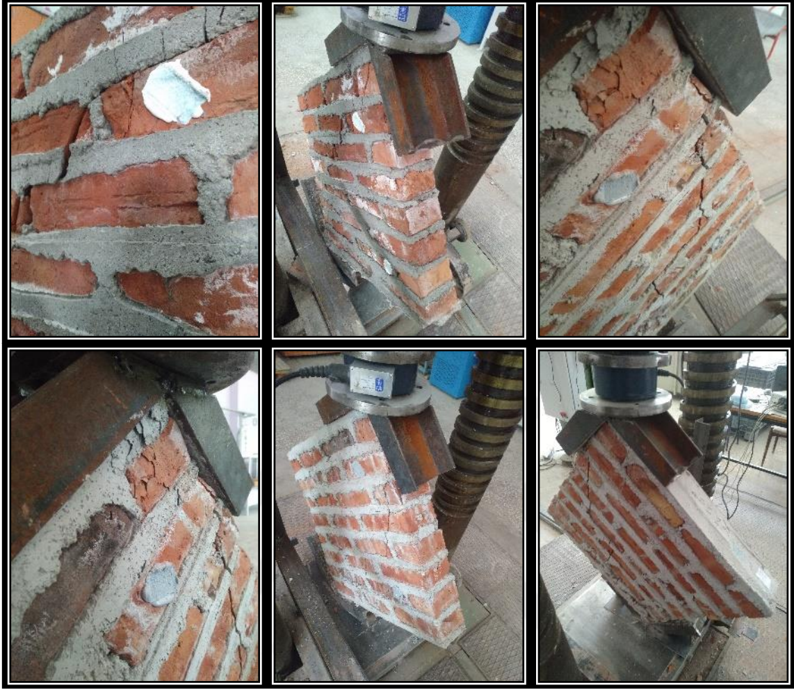
Şekil E1.2. D1L1O2 tip duvarlara ait hasar fotoğrafları
