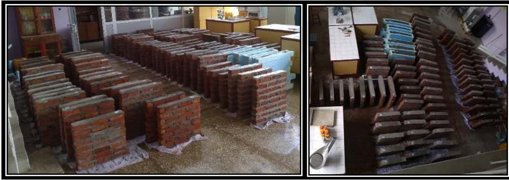
Şekil 6.16. Yığma duvar elemanları
