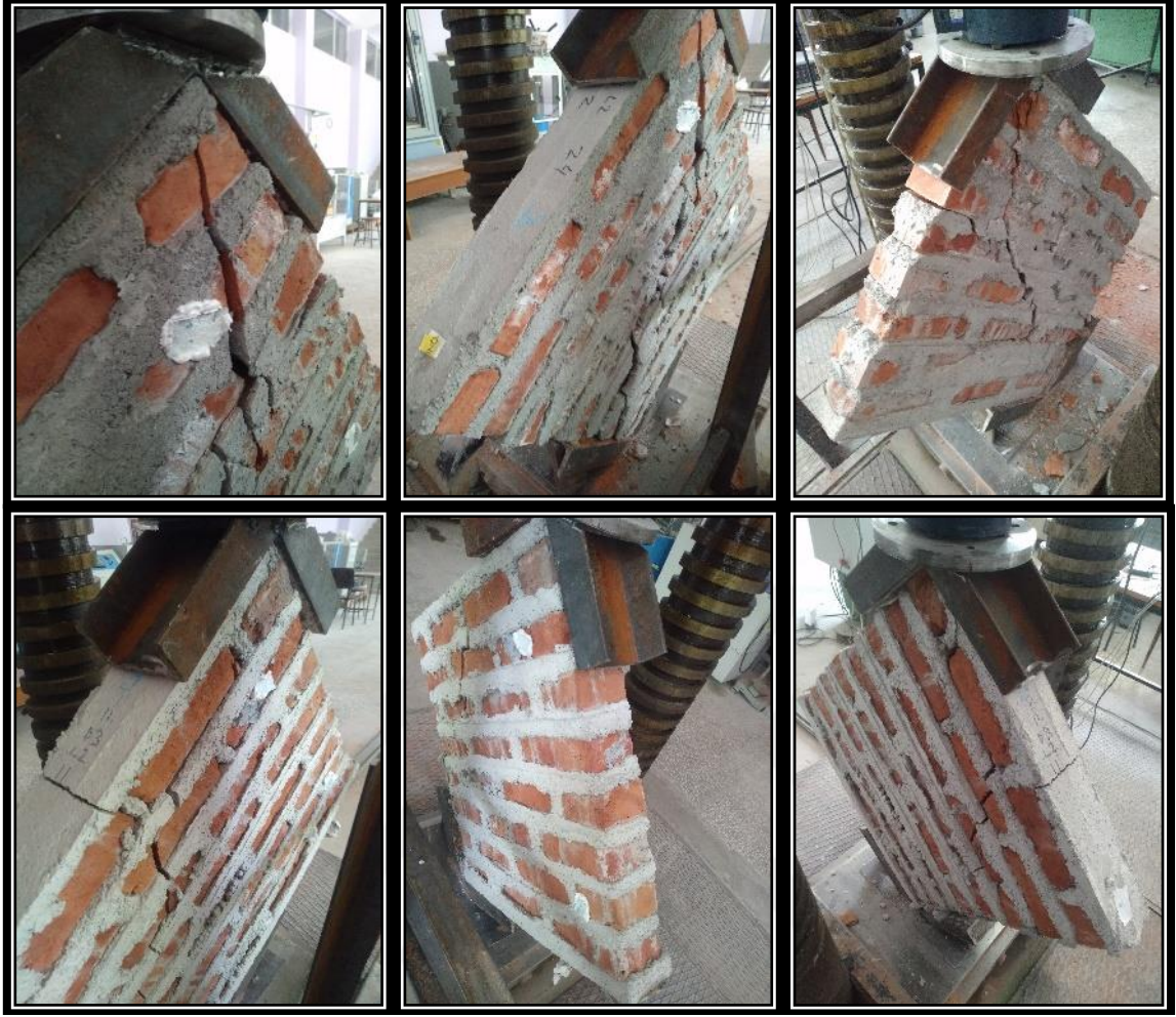
Şekil E1.29. D3L2O2 tip duvarlara ait hasar fotoğrafları
