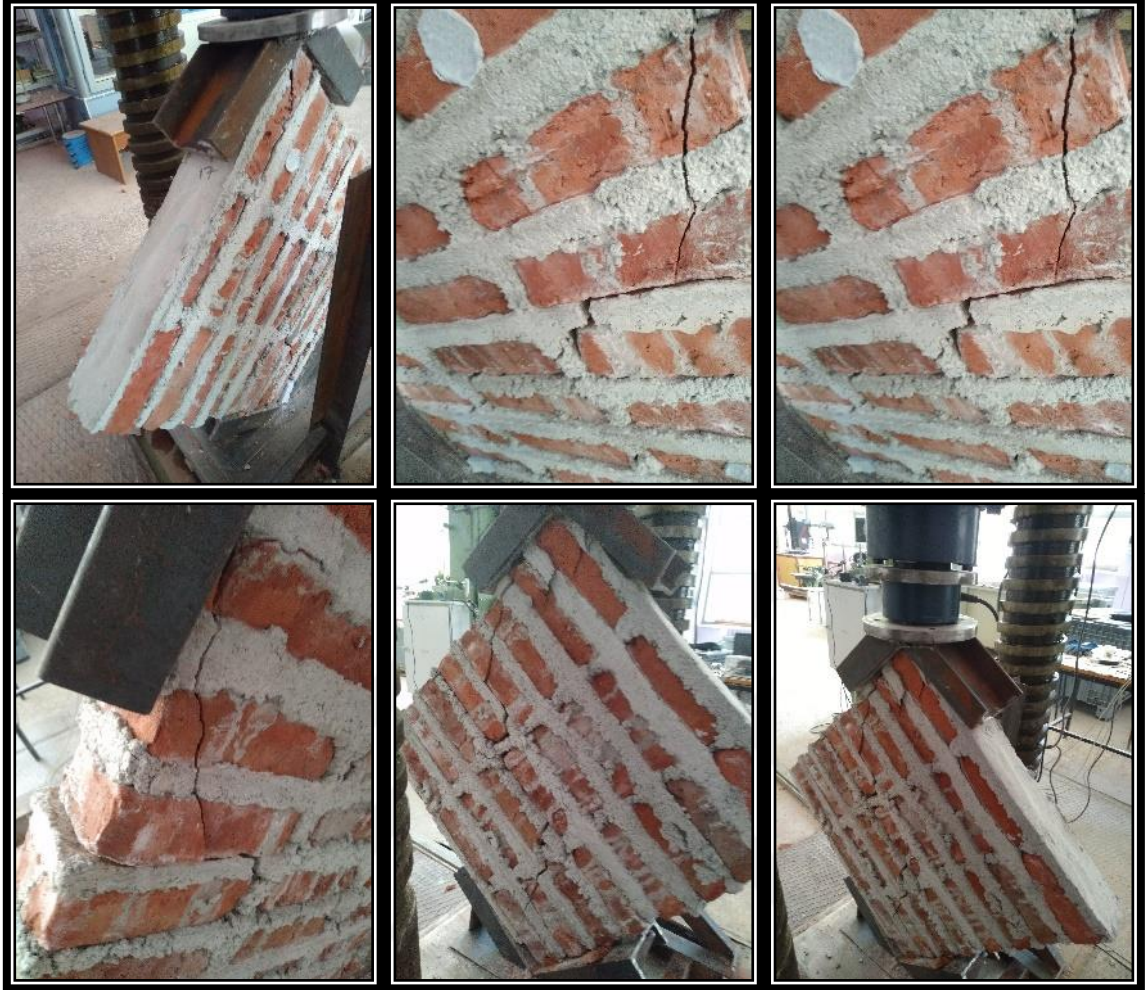
Şekil E1.13. D2L1O1 tip duvarlara ait hasar fotoğrafları
