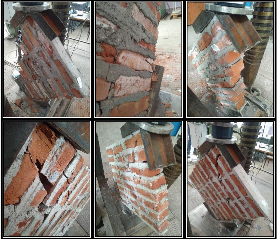
Şekil E1.4. D1L2O1 tip duvarlara ait hasar fotoğrafları
