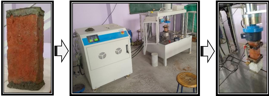
Şekil 6.7. Tuğlaların elastisite modüllerinin belirlenmesi süreci
