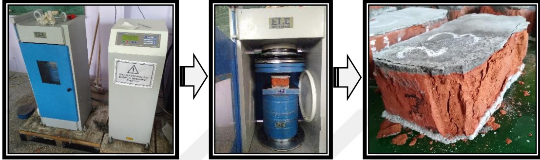
Şekil 6.6. Tuğlaların basınç dayanımlarının belirlenmesi süreci
