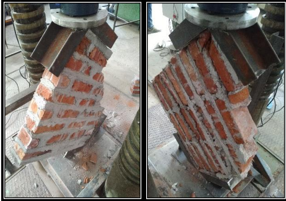
Şekil 7.3. Ayrılarak göçmeye uğrayan duvarlara örnekler
