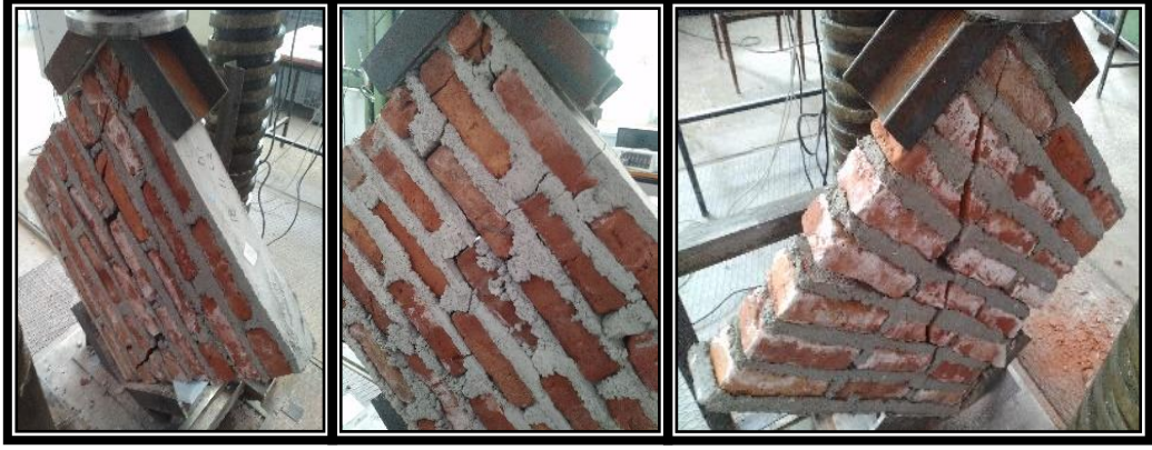
Şekil 7.4. Toptan göçmenin meydana gelmediği duvarlara örnekler
