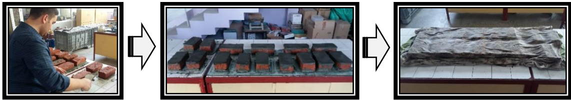
Şekil 6.5. Tuğlaların yükleme yönüne dik yüzeylerinin çimento harcı ile başlıklanması
