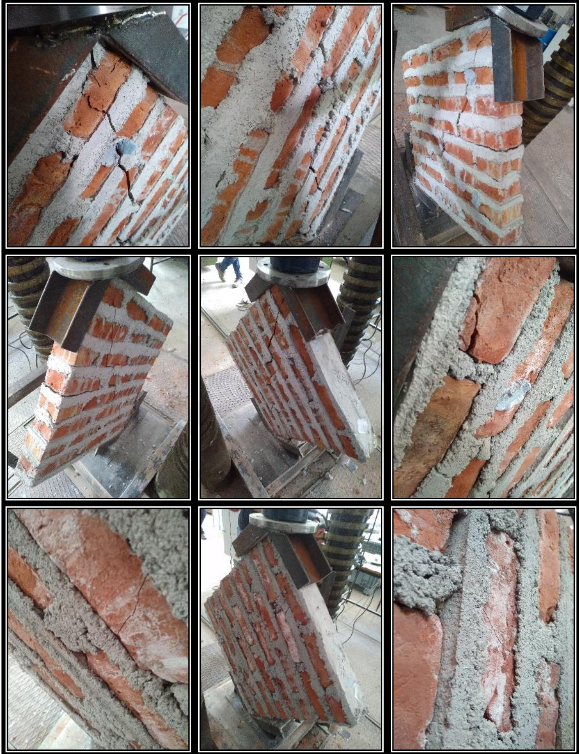
Şekil E1.17. D2L2O2 tip duvarlara ait hasar fotoğrafları
