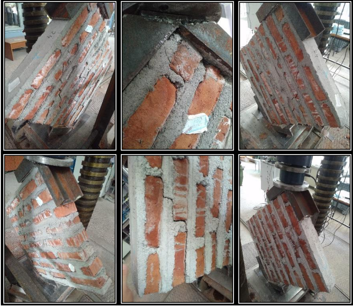
Şekil E1.30. D3L2O3 tip duvarlara ait hasar fotoğrafları
