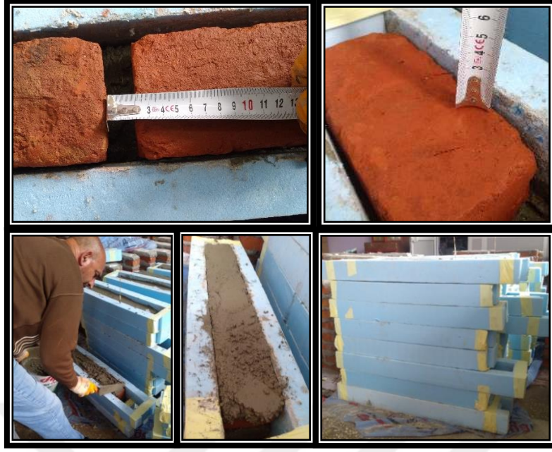
Şekil 6.15. Yığma duvar elemanlarının hazırlanması
