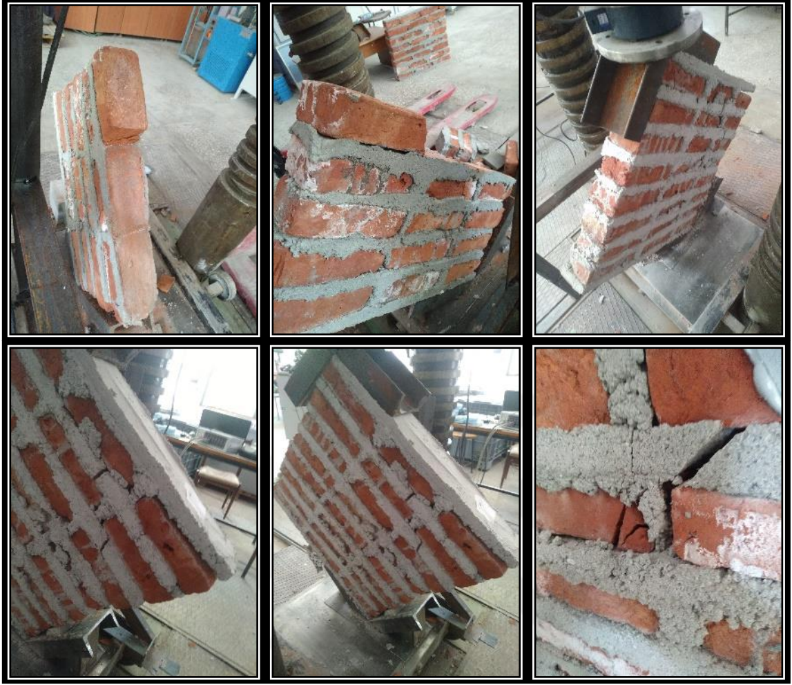
Şekil E1.16. D2L2O1 tip duvarlara ait hasar fotoğrafları
