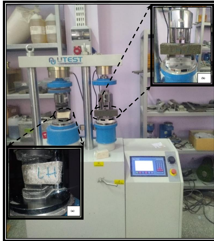
Şekil 6.12. Harç numuneleri için a) basınç ve b) eğilme çekme deneyleri
