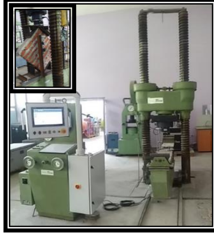
Şekil 6.19. Diyagonal basınç testlerinin gerçekleştirildiği basınç test presi
