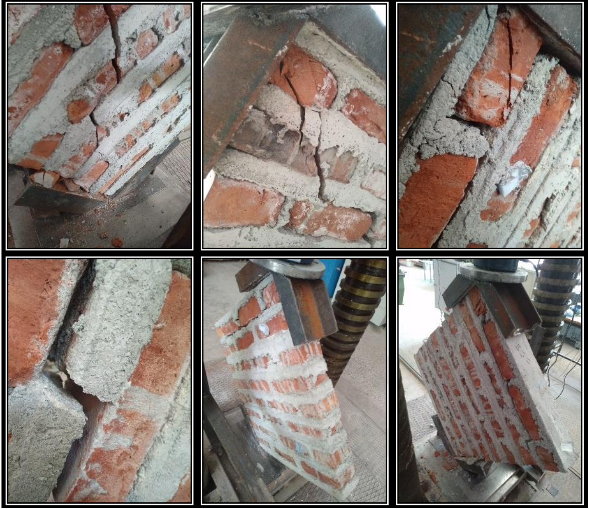
Şekil E1.26. D3L1O2 tip duvarlara ait hasar fotoğrafları
