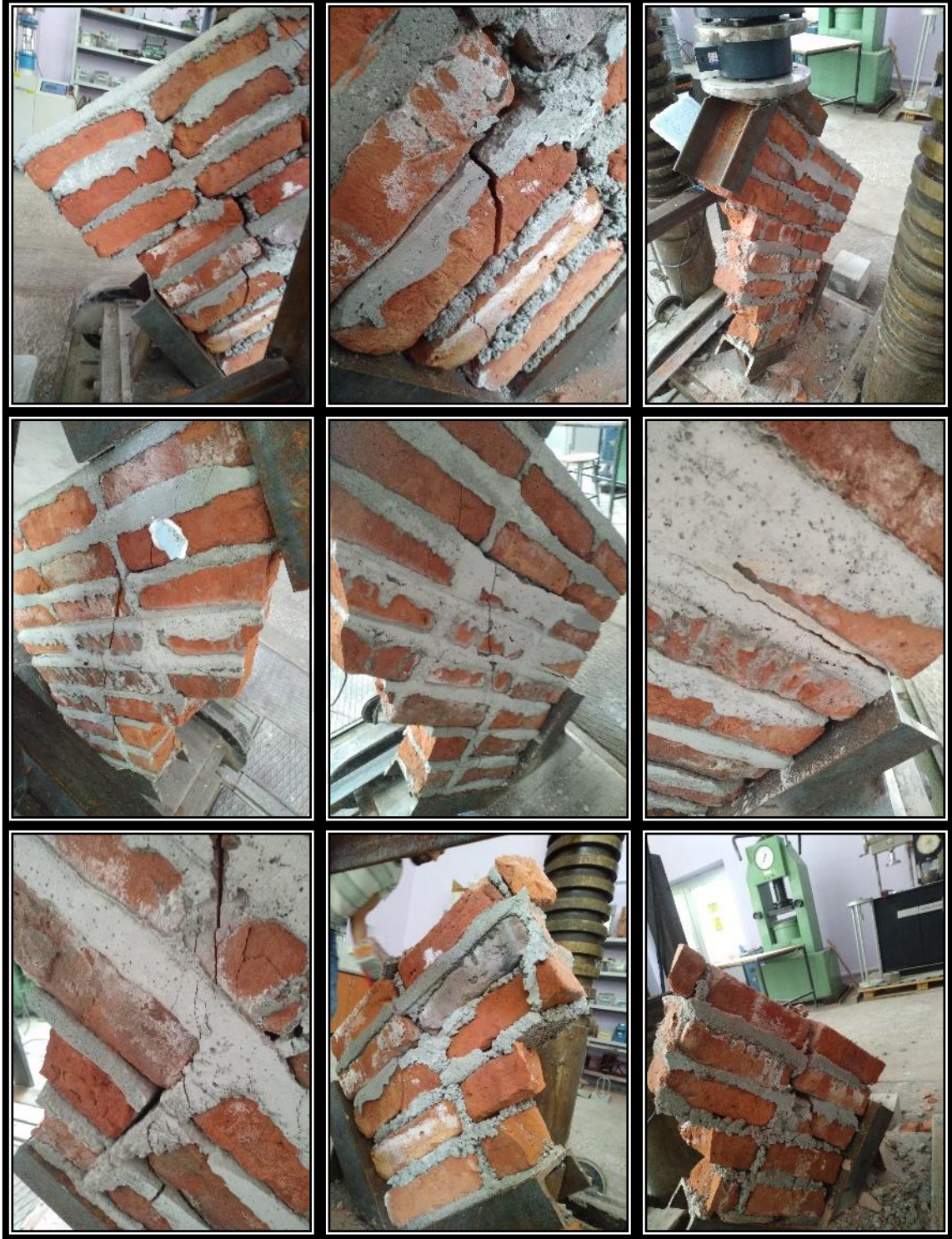
Şekil E1.10. D1NHO1 tip duvarlara ait hasar fotoğrafları
