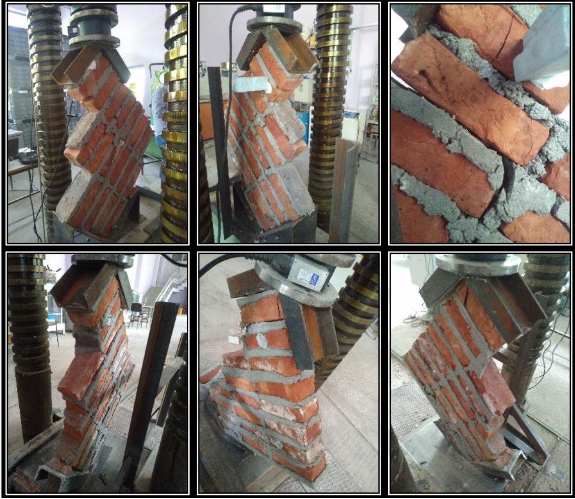
Şekil E1.22. D2NHO1 tip duvarlara ait hasar fotoğrafları
