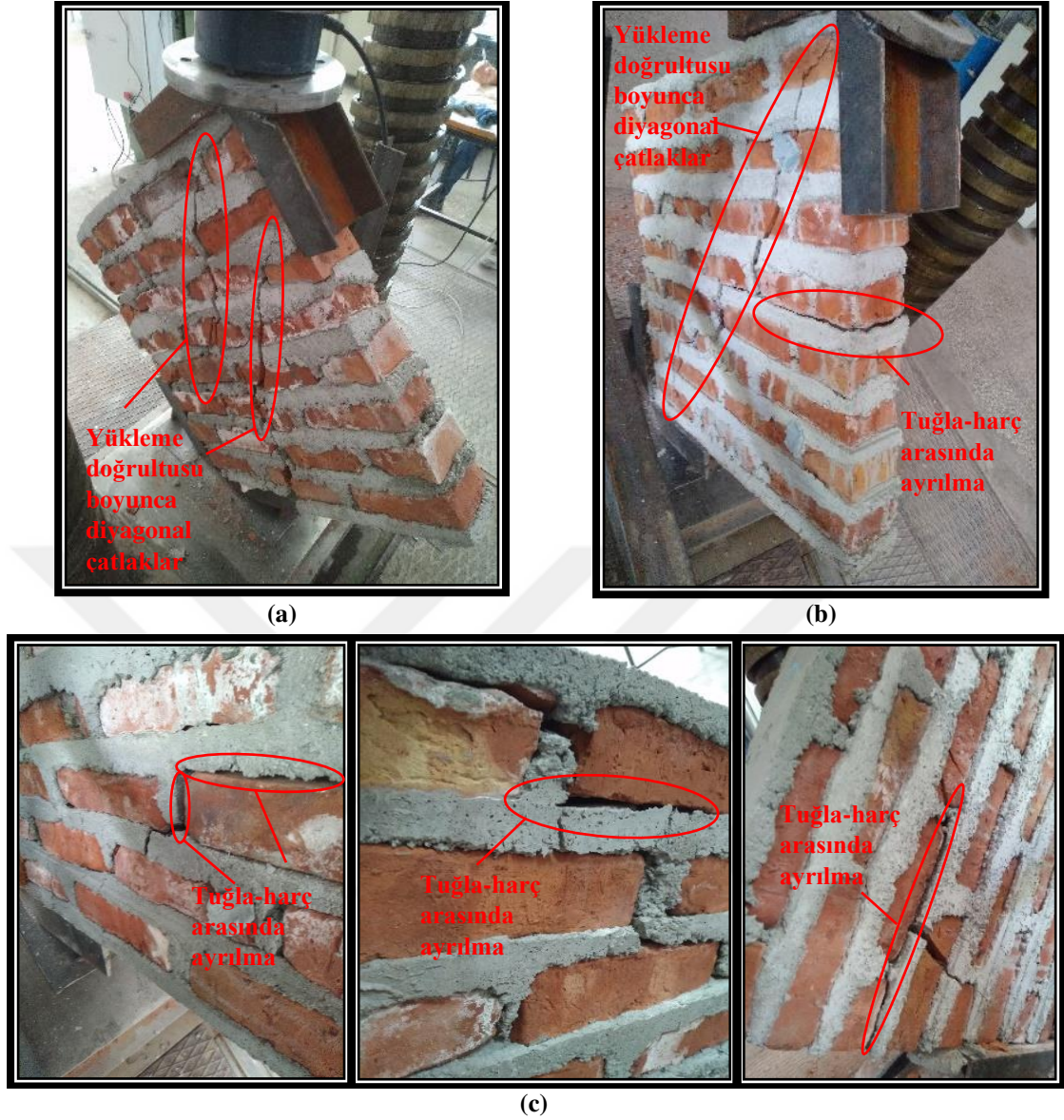
Şekil 7.1. Yüklemeye doğrultusu boyunca oluşan diyagonal çatlaklar ve tuğla ile harç arasındaki ayrılmalar
