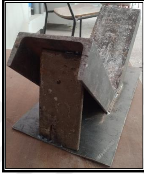
Şekil 6.18. Diyagonal basınç testlerinde kullanılan çelik başlıklar
