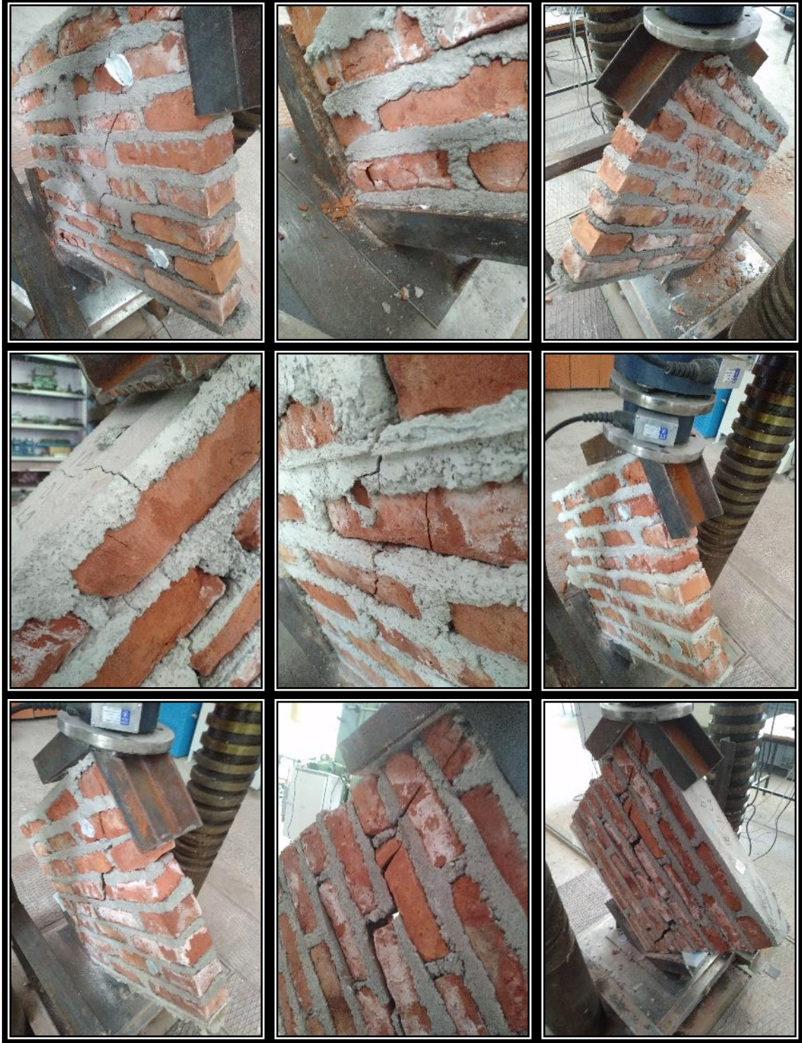
Şekil E1.5. D1L2O2 tip duvarlara ait hasar fotoğrafları
