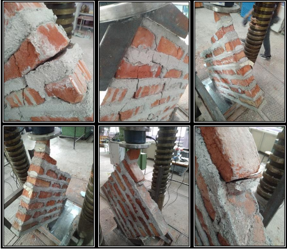
Şekil E1.36. D3NHO3 tip duvarlara ait hasar fotoğrafları
