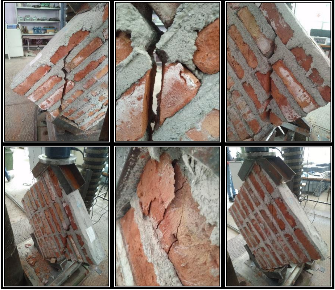
Şekil E1.7. D1L3O1 tip duvarlara ait hasar fotoğrafları
