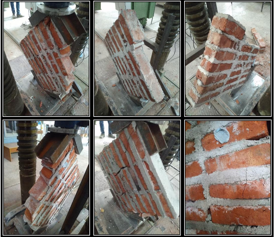
Şekil E1.1. D1L1O1 tip duvarlara ait hasar fotoğrafları
