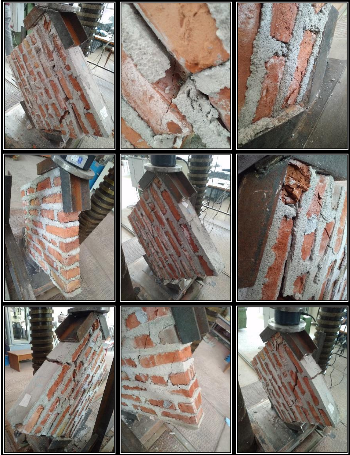
Şekil E1.9. D1L3O3 tip duvarlara ait hasar fotoğrafları
