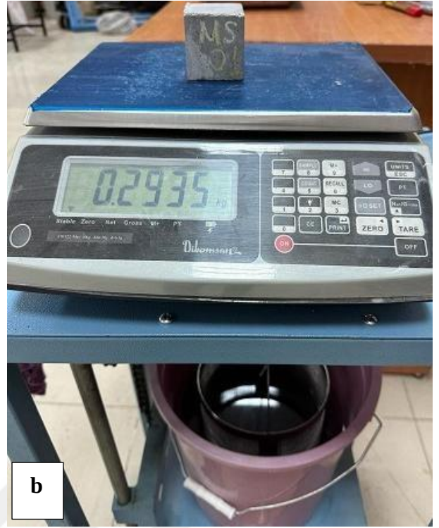
Şekil 12: Kür Aşamasındaki Numune örnekleri (a), Kür Havuzundan Çıkarıldıktan Sonra Yapılan Ölçüm (b)
