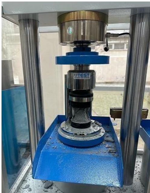
Şekil 13: Numunelerin Beton Pres Makinesinde Dayanımının Belirlenmesi
