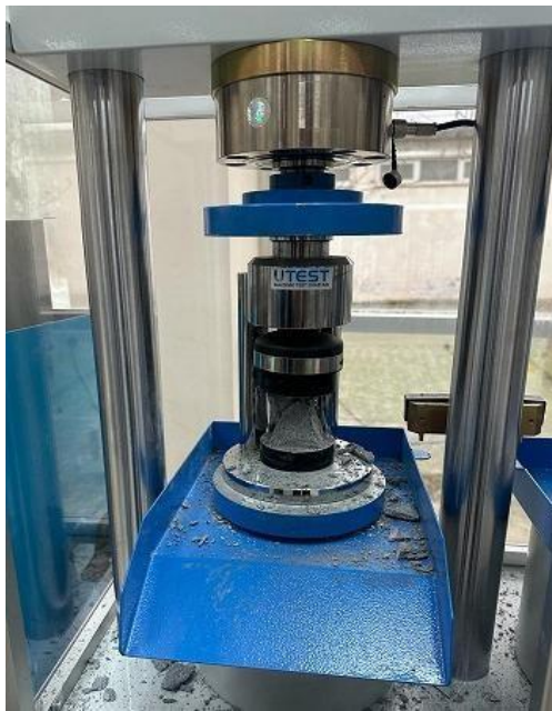
Şekil 13: Numunelerin Beton Pres Makinesinde Dayanımının Belirlenmesi
