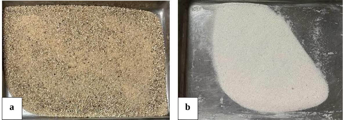
Şekil 6: Karışımda Kullanılan; İnce Agrega (a), Kuvars Kumu (b).
