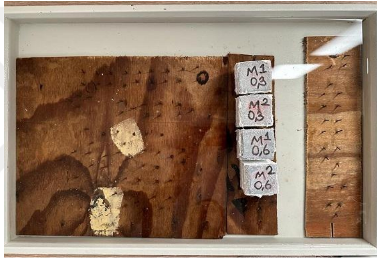
Şekil 14: Kılcal Su Emme Deney Düzeneği
