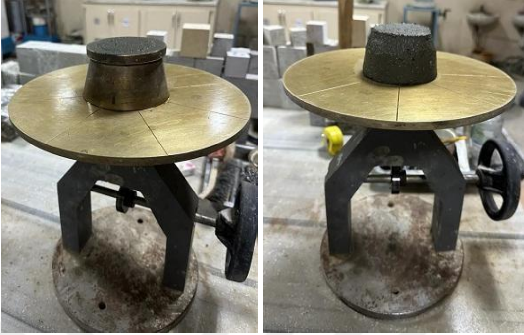
Şekil 11: Hazırlanan Harç Karışımının Yayılma Tablası Üzerinde Kalıba Yerleştirilmesi
