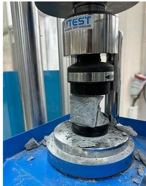
Şekil 13: Numunelerin Beton Pres Makinesinde Dayanımının Belirlenmesi
