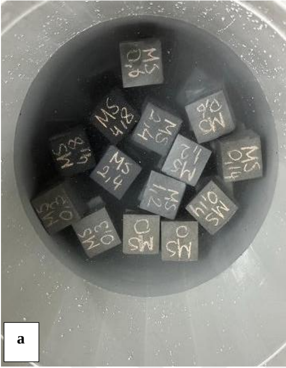
Şekil 12: Kür Aşamasındaki Numune örnekleri (a), Kür Havuzundan Çıkarıldıktan Sonra Yapılan Ölçüm (b)
