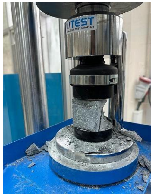
Şekil 13: Numunelerin Beton Pres Makinesinde Dayanımının Belirlenmesi
