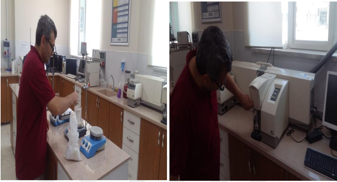
Şekil 3.11 Numunelerin tane boyut analizi için hazırlanması (solda) ve Malvern Mastersizer 2000 cihazında tane boyut ölçümü (sağda).
