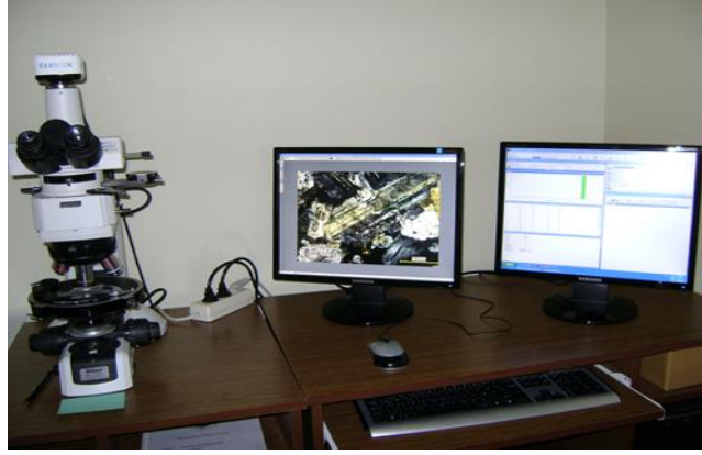
Şekil 3.9 Çalışmalarda petrografik analizler için kullanılan polarizan mikroskop.
