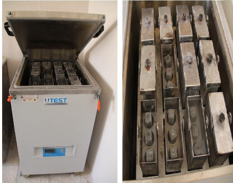
Şekil 3.13 Alkali silika deneylerinin yapıldığı test kabini.
