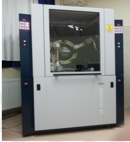
Şekil 3.8 Çalışmalarda mineralojik analizler için kullanılan XRD cihazı.
