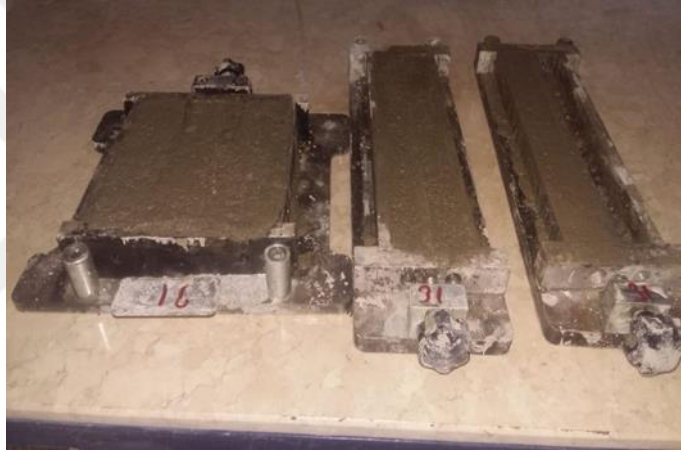
Şekil 2.5 ASR deneyi için hazırlanan harç çubukları (Bu tez çalışması).
