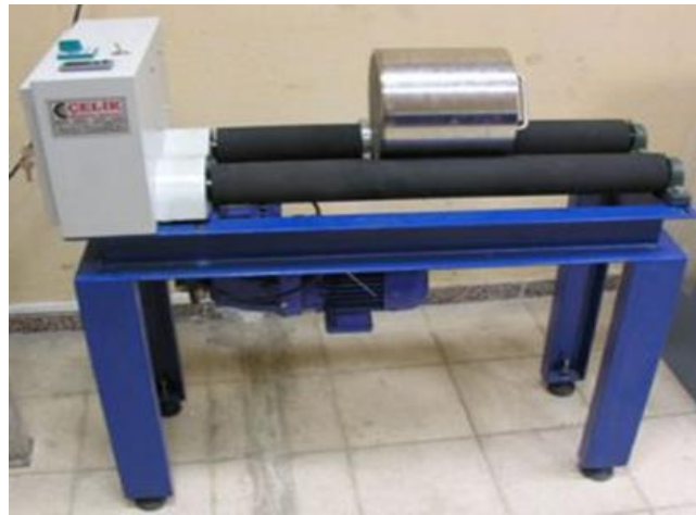
Şekil 3.10 Öğütme deneylerinde kullanılan değirmen ve çelik hazne.
