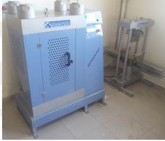
Şekil 3.14 Basınç dayanımı testinde kullanılan hidrolik pres.
