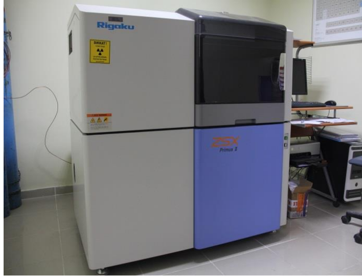
Şekil 3.7 Çalışmalarda kimyasal analizler için kullanılan XRF cihazı.
