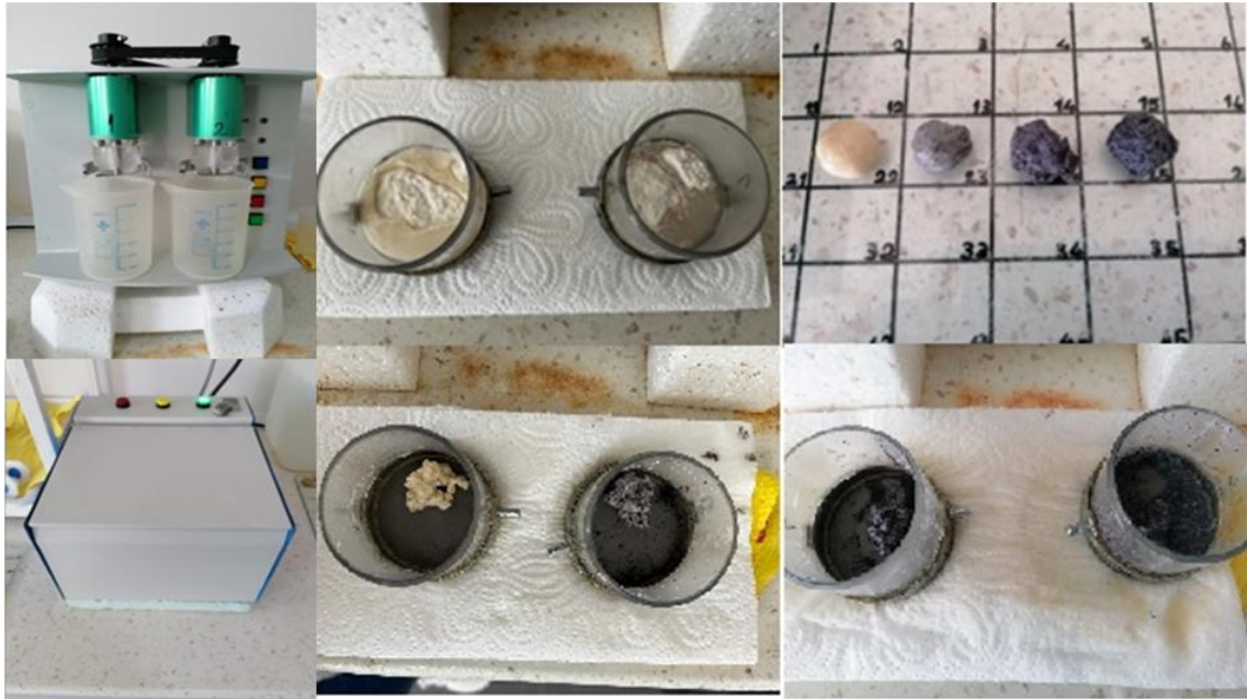
Resim 3.5 Glutomatik sistem cihazı ile indeks cihazının görüntüsü ve test edilen analiz örnekleri
