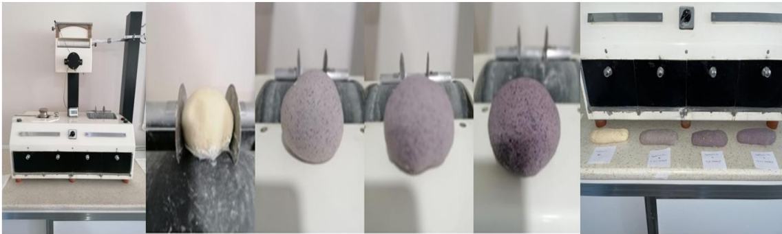
Resim 3.4 Ekstensograf ölçümü yapılan cihaz, ekstensograf için yuvarlama yapılan örnekler ve ekstensograf için silindir yapılan örnekler
