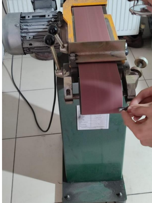
Şekil 4.16. Bakalite alma işlemi öncesi zımparalama yapılması.
