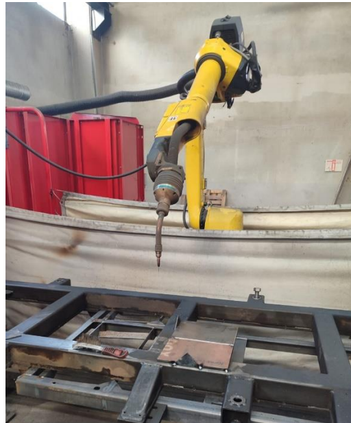
Şekil 4.2. Kaynakta kullanılan robot kaynak makinesi.
