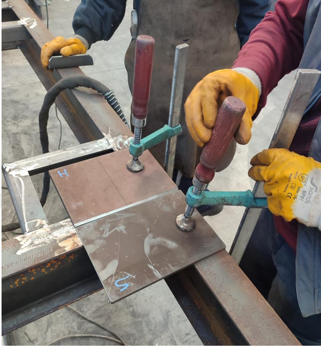
Şekil 4.6. Hardox 450 ve S355J2C+N numunelerin puntalama işlemi.
