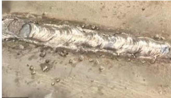
Şekil 2.10. Kaynakta oluşan sıçramalar.
