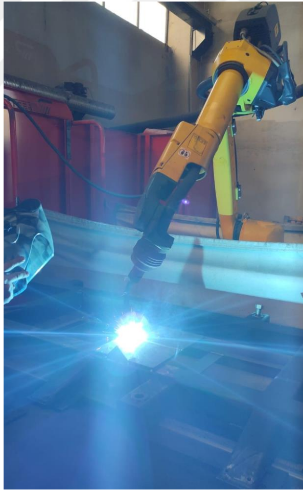
Şekil 4.8. Hardox 450 ve S355J2C+N parçaların kaynak işlemi.
