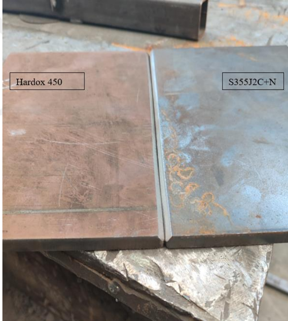
Şekil 4.5. Hardox 450 ve S355J2C+N numunelerin V kaynak ağzı açma işlemi.
