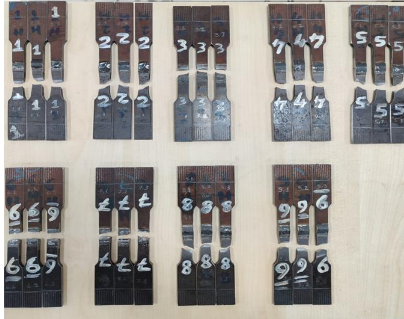
Şekil 5.1. Çekme deneyi sonucu numunelerin hasar yerleri.
