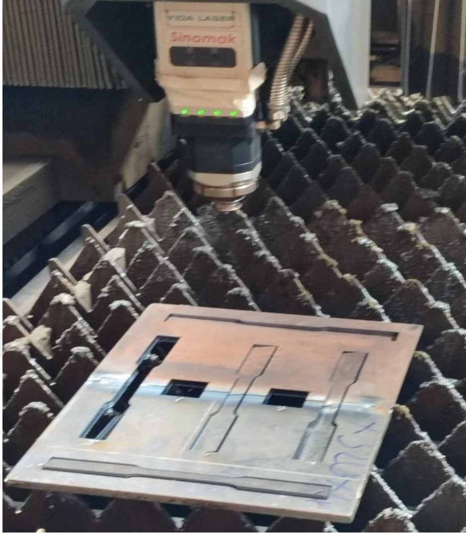
Şekil 4.11. Kaynaklı plakadan test numunelerinin kesilmesi.
