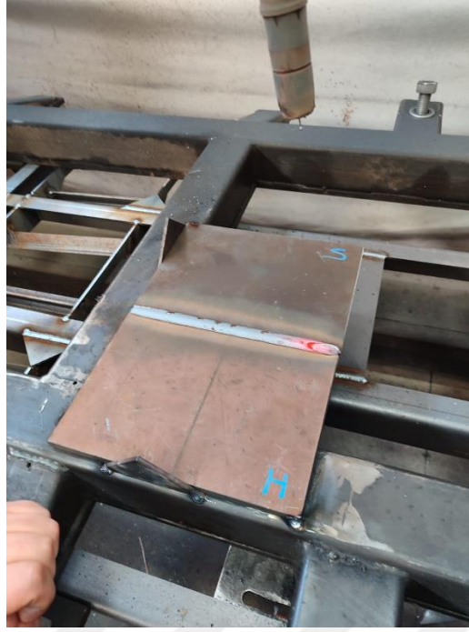
Şekil 4.9. Hardox 450 ve S355J2C+N kaynaklanmış numune parçalar.
