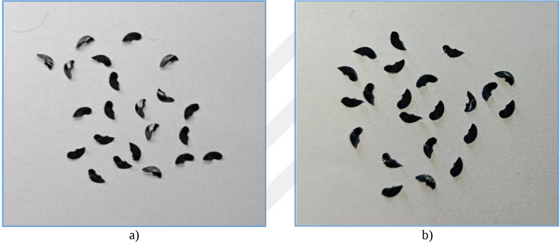
Şekil 5. 9. İş parçasının V=30 m/dk, f_z=0,03 mm/diş ve a_p=1,2 mm parametreleri ile işlenmesi sonucu oluşan talaşlar a) kriyojenik işlem uygulanmamış kesici takım ile işleme sonucu b) kriyojenik işlem uygulanmış kesici takım ile işleme sonucu
