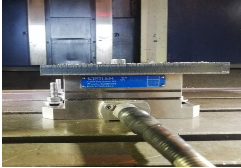
Şekil 4. 8. İş parçasının KISTLER marka dinamometreye bağlanma şekli
