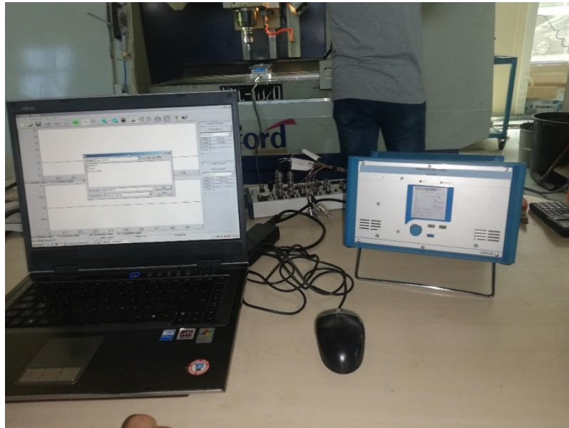
Şekil 4. 11. Kuvvet ölçüm cihazına bağlı bilgisayar
