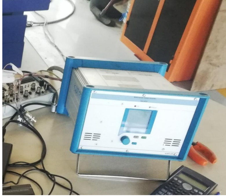
Şekil 4. 9. KISTLER KST 5070B model sinyal güçlendirici
