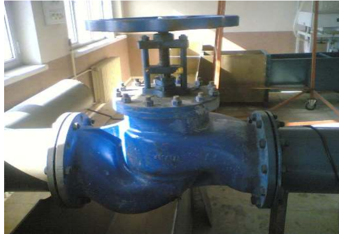
Şekil 5.5. Giriş debisinin ayarlandığı debimetrenin ön kısmındaki vana
