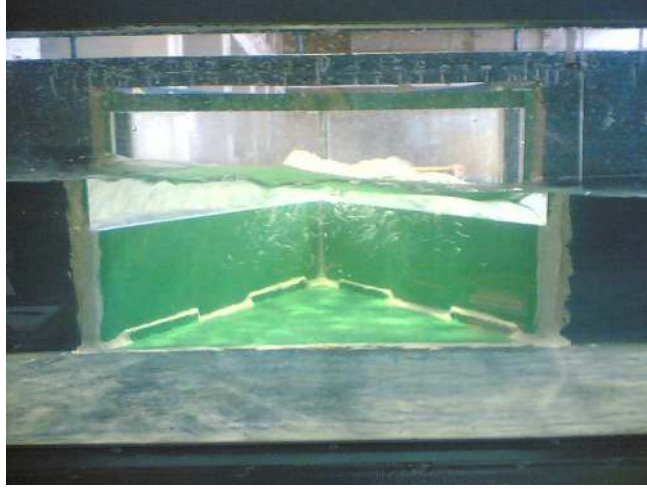
Şekil 5.1 Labirent yansavak üzerindeki akım
