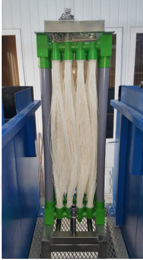
Şekil 3.1. Sistemde kullanılan membran modülü (PVDF 0.04 µm, 10 m2 yüzey alanlı Hollow Fiber)
