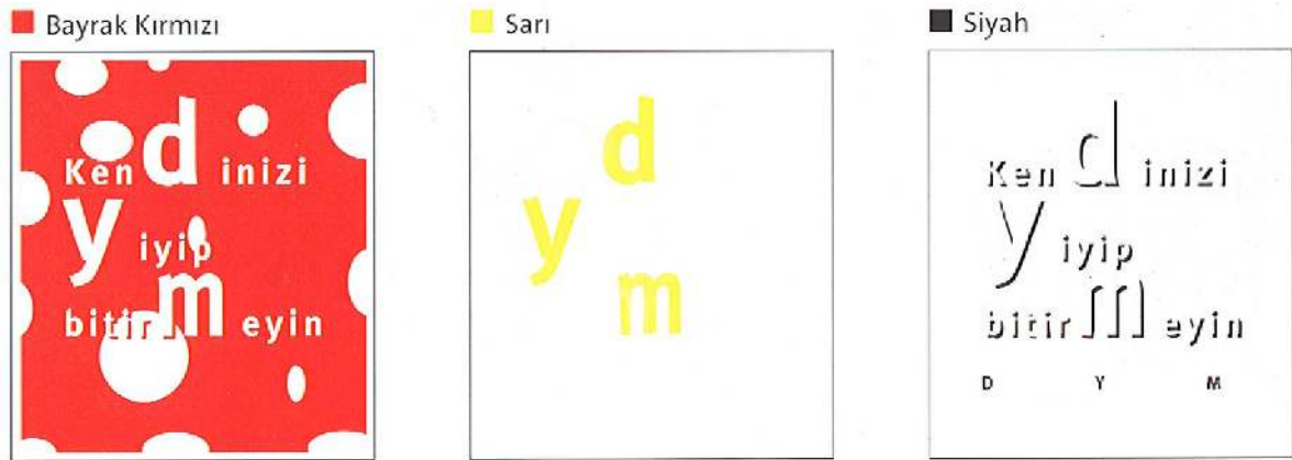
Şekil 6.22 Tek ton Spot renk ayrımı
