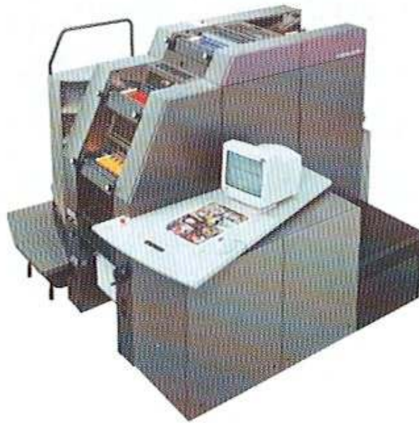
Şekil 5.10 Heidelberg Quickmaster DI ofset baskı makinesi
