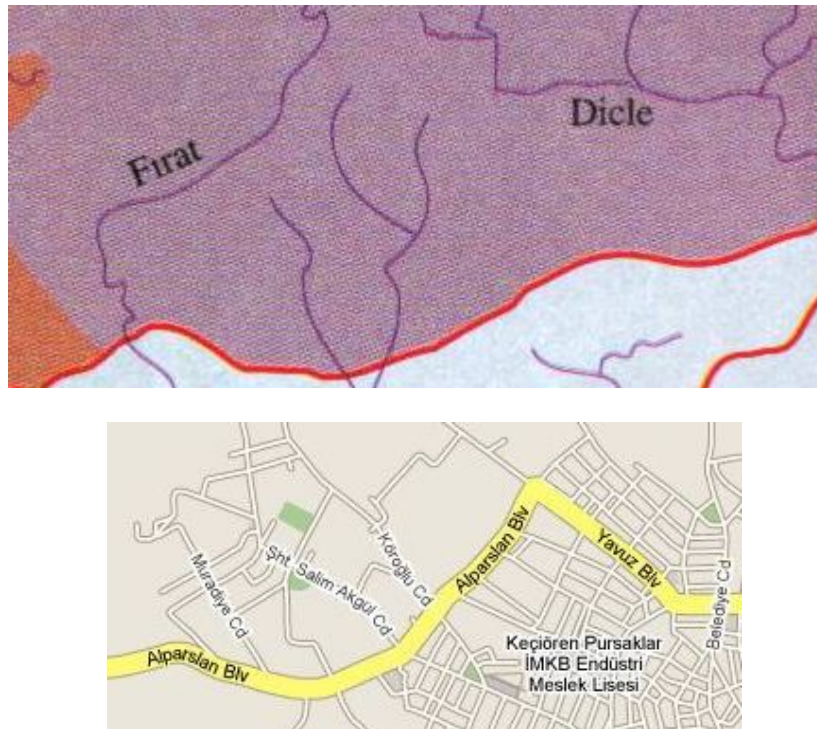
Şekil 4.13 Çizgi detaylarda isimlerin yazılması (İnt.Kyn.3)
