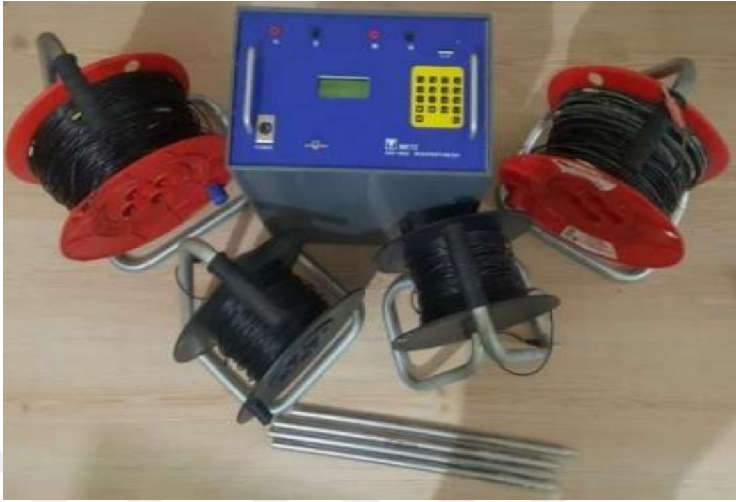
Şekil 5. DES ölçüm cihazı ile ekipmanları (elektrotlar ve kablolar)
