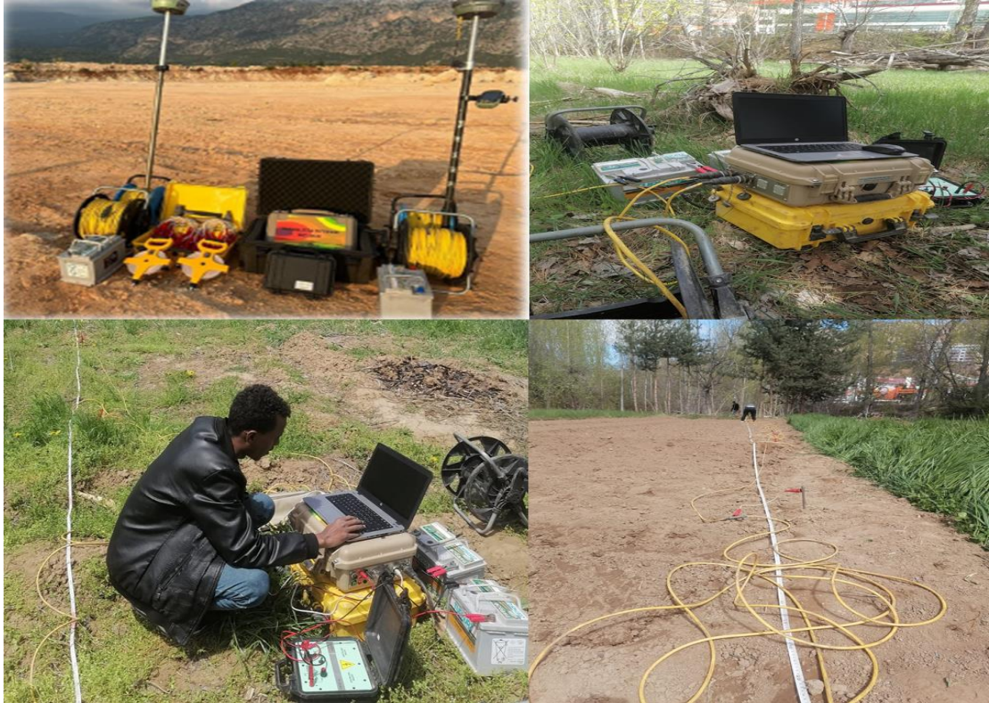
Şekil 7. ERT ölçüm ekipmanı ve arazi çalışması
