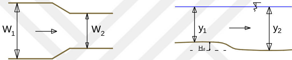
Şekil 11. Daralma oyulması (Yanmaz, 2002).
