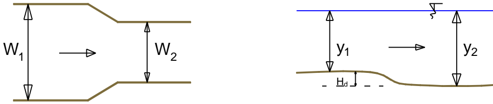
Şekil 11. Daralma oyulması (Yanmaz, 2002).
