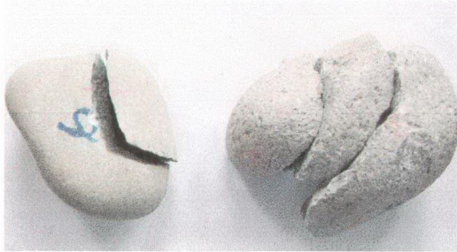
Şekil 2.8. Geçersiz kırılma gösteren numuneler
