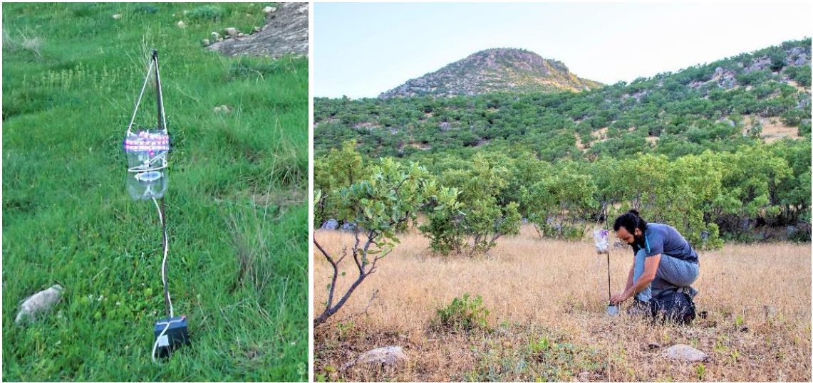
Şekil 3.3. Özel UV ışık tuzağı ve kurulması
