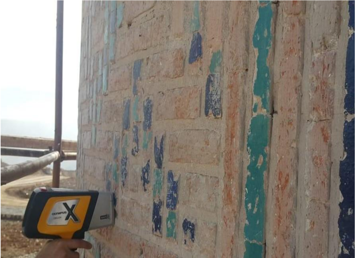
Şekil 7. 2. Zeynel Bey Türbesine ait Koyu Mavi Çinilerin P-XRF cihazı ile analizinin yapılması.
