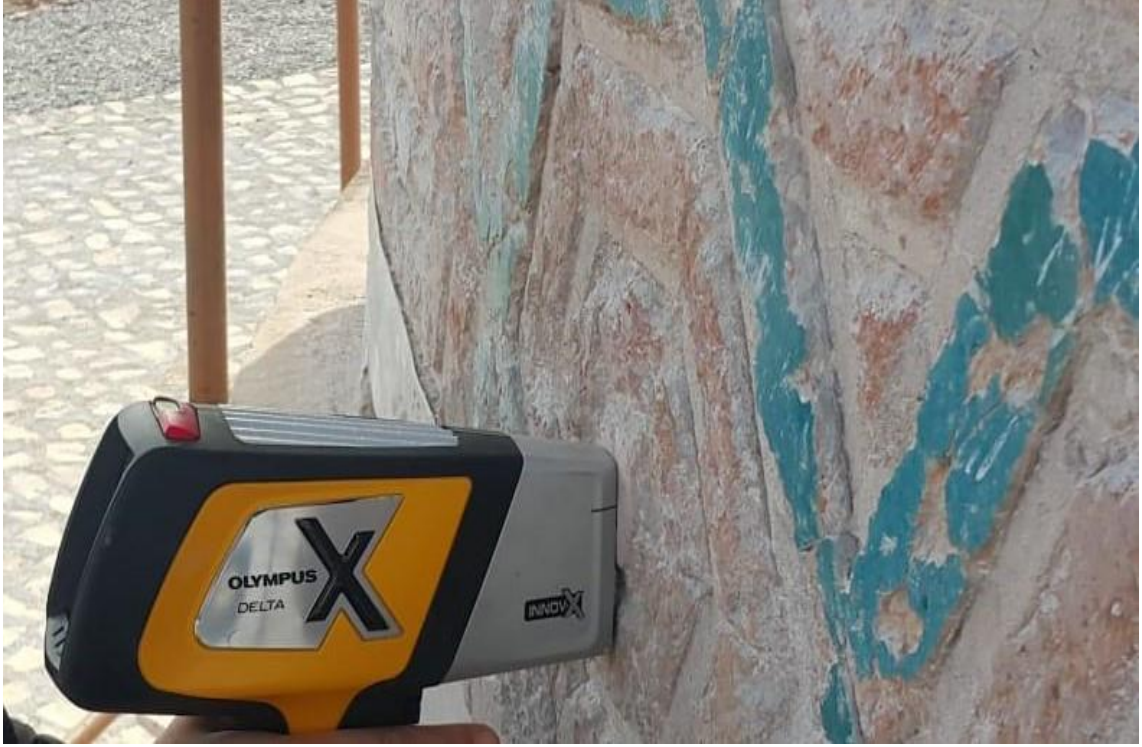
Şekil 7. 3. Zeynel Bey Türbesine ait Sırsız Kiremitlerin P-XRF cihazı ile analizinin yapılması.
