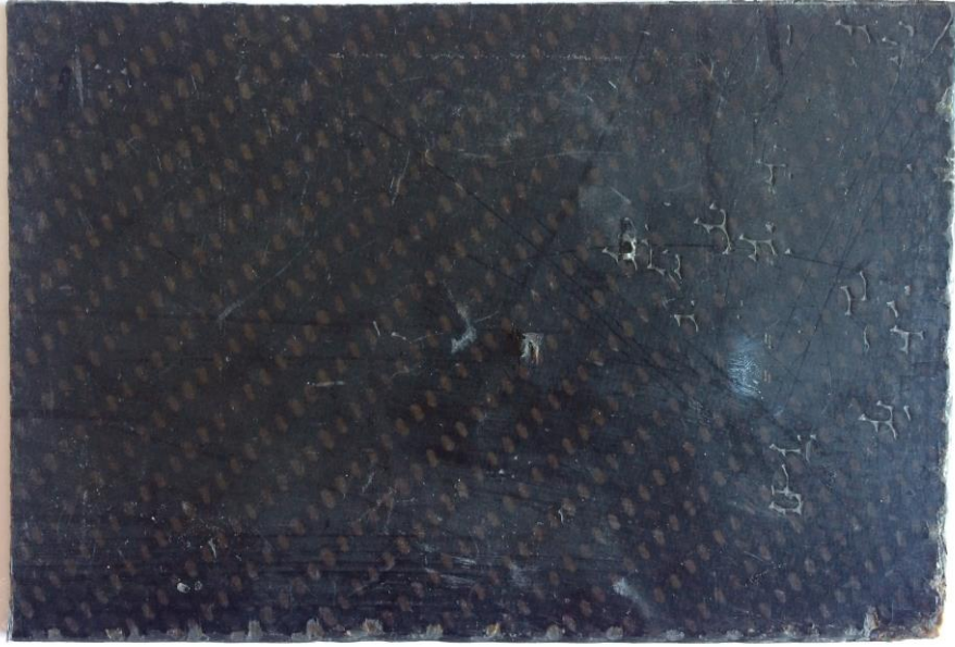
Şekil 4.20 1.5 mm kalınlıkta 6.13 J enerji ile hasara uğratılmış plaka.
