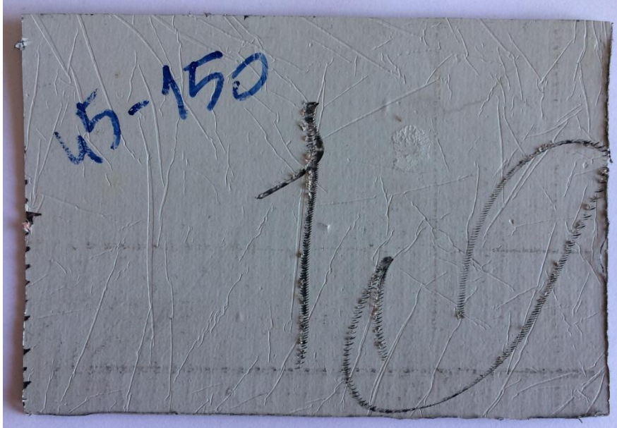
Şekil 4.16 1 mm kalınlıkta 1.84 J enerji ile hasara uğratılmış plaka.
