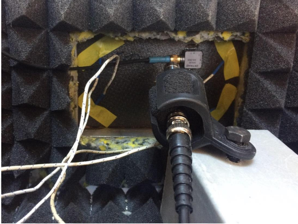
Şekil 4.8 Veri toplanan bölmedeki ivme ölçer ve termokapllar yapıştırılmış numune.
