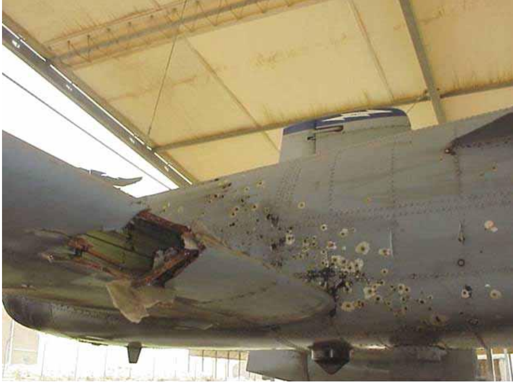
Şekil 2.1 Bir savaş uçağının yapısal hasarı (Philip, Larson The Air Force Research Labrotary [AFLR], 2008 )
