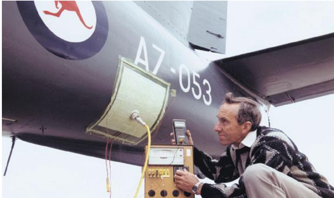
Şekil 2.4 Bir uçak gövdesinin yama ile onarımı (Defence Science and Technology Organisation (n.d.) www.dsto.defence.gov.au )
