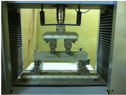
Resim 3.11. ECC numunesinin 4 noktalı eğilme deneyi
