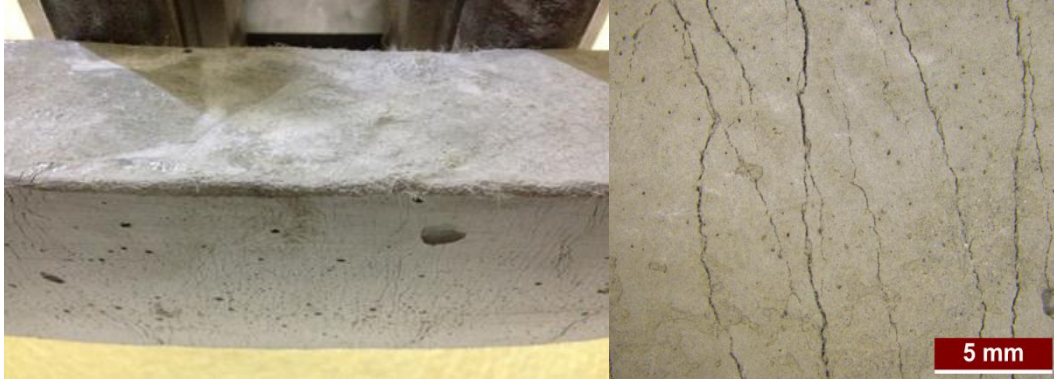
Resim 2.1. ECC'nin eğilme yüklemeleri altında çoklu çatlak gelişimi
