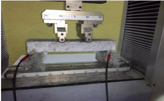
Resim 3.14. Aynı anda yapılan ED ve 4 noktalı eğilme testleri
