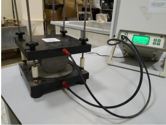
Resim 3.12. Eksenel konfigürasyona sahip iki problu elektriksel direnç ölçüm sistemi
