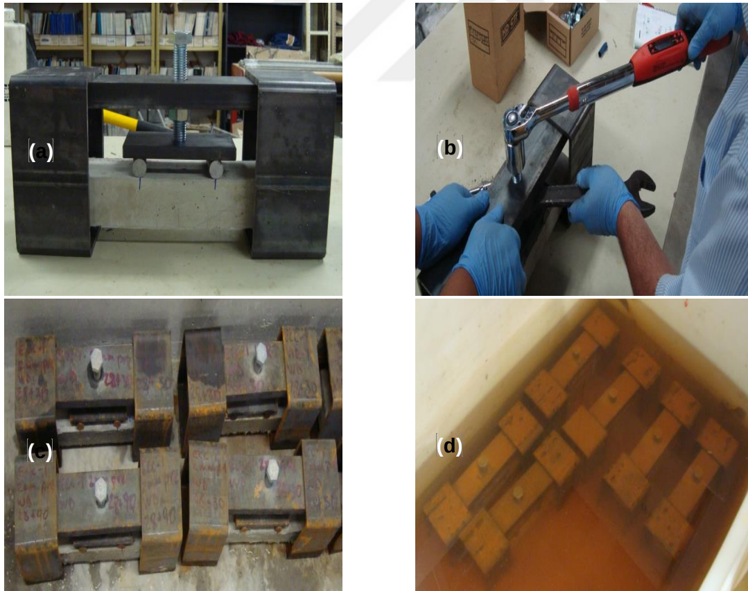
Resim 2.3. (a) Hasarlı numunelerde sürekli yükleme uygulaması için ekipman, (b) tork anahtarı ile sürekli yükleme seviyesinin artırılması, (c) kür için hazır durumda olan numuneler, (d) kendiliğinden iyileşme için suya konmuş numuneler (Yıldırım ve diğerleri, 2015d)
