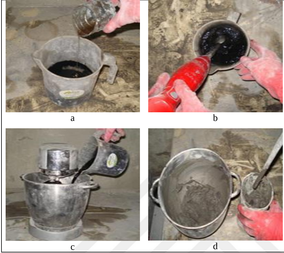
Resim 3.9. (a) YOSA ilavesi, (b) yüksek frekansta karışımın hazırlanması, (c) KNT solüsyonunun esas karışıma aktarılması, (d) karışımların kalıplara dökülmesi
