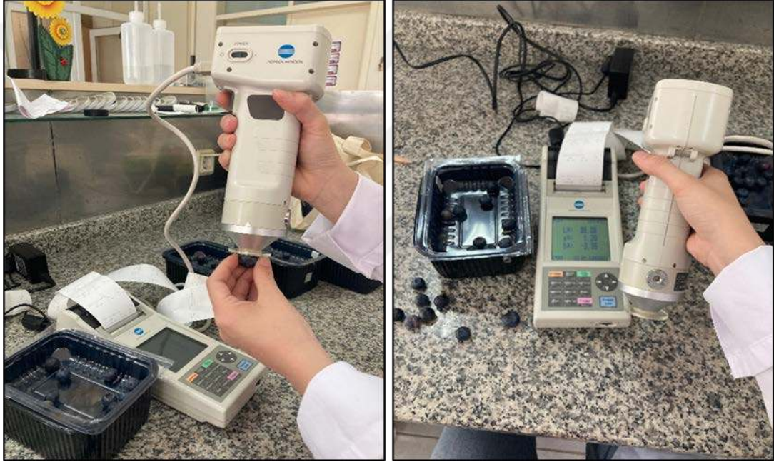
Şekil 3. 9. Minolta CR-400 model renk ölçüm cihazı ve Maviyemiş Meyvelerinde Renk Ölçümü
