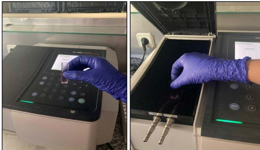
Şekil 3. 16. Shimadzu UV-1800 spektrofotometre cihazında okuma yapılırken görünüm
