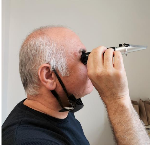
Fotoğraf 3.13. Suda çözünabilir kuru madde (SÇKM) miktarının ölçümü.
