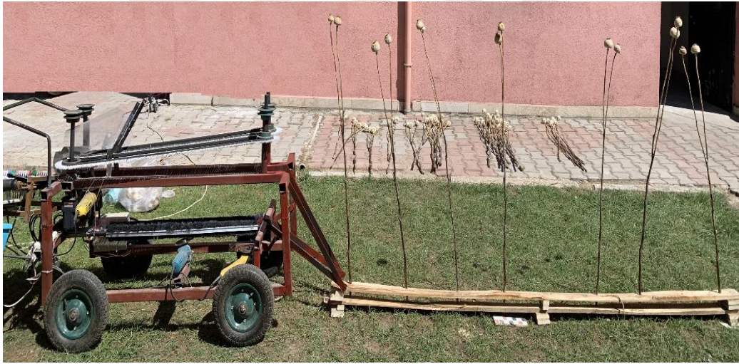
Şekil 4.34. İki kapsüllü haşhaş hasadı laboratuvar denemesi
