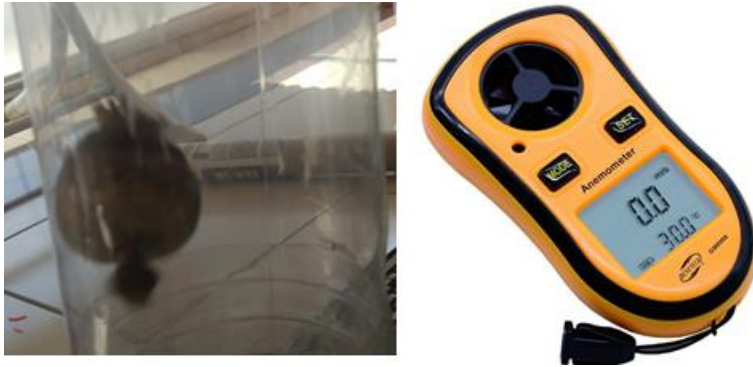
Şekil 3.25. Haşhaş kapsülü kritik hız belirlenmesi
