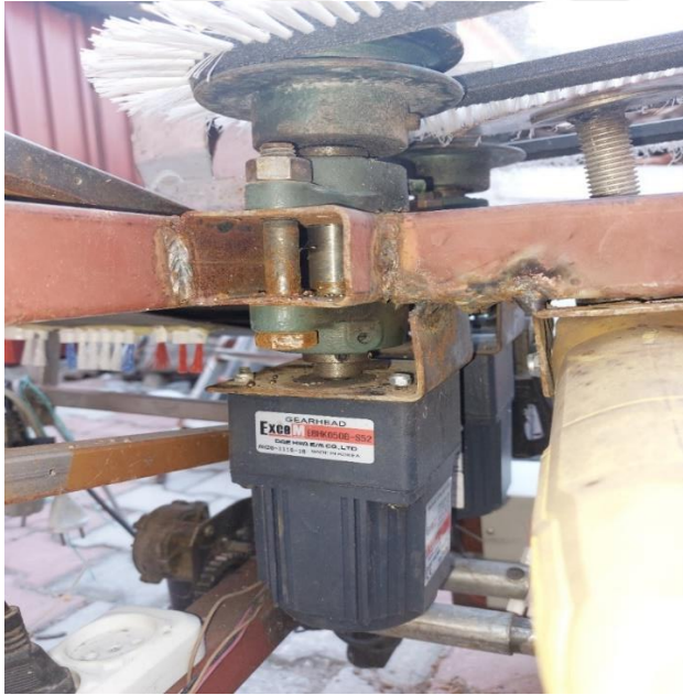
Şekil 3.26. Çift rulmanlı motor mili bağlantısı
