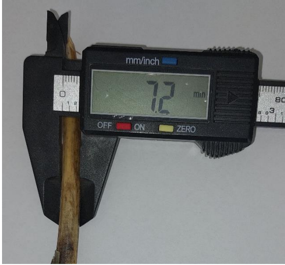
Şekil 3.19. Haşhaş sapı kalınlık ölçümleri
