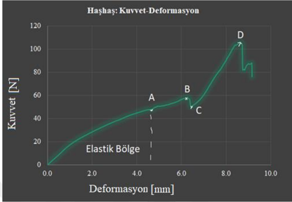
Şekil 3.27. Haşhaş sapı kuvvet-deformasyon eğrisi
