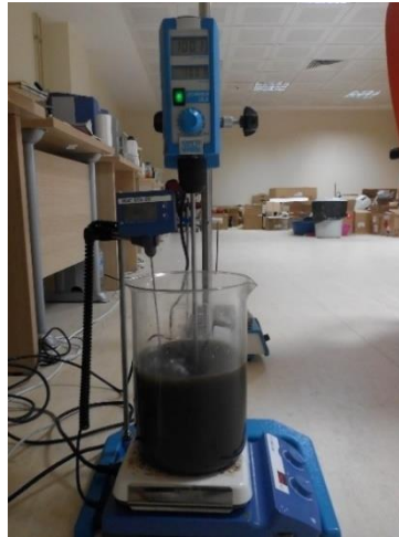
Şekil 2. 25 Kurutma işlemi sonrasında yağa ağartma toprağının eklenmesi
