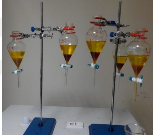
Şekil 2. 28. Transesterifikasyon reaksiyonu sonunda ayırma hunisine alınan biyodizellerin gliserolle oluşturduğu faz farkı
