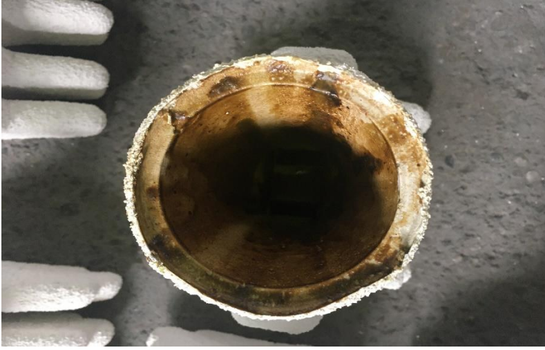
Şekil 46. Yakma İşlemine Uğramamış Seramiğin İç Yüzeyi
