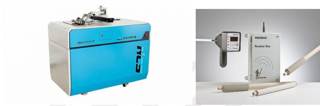
Şekil 17. Optik Emisyon Spektrometresi ve Dökümde Kullanılan Termokupl
