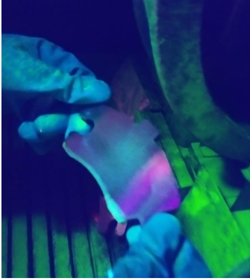
Şekil 92. Kabul Kriterindeki Parçanın NDT'si
