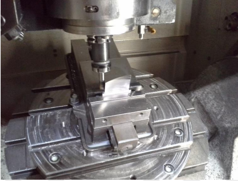
Şekil 11. 5 Eksenli CNC Tezgahta İşlenen Mum Enjeksiyon Kalıbı
