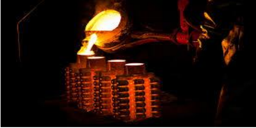
Şekil 8. Hassas Döküm Seramiğine Döküm Anı
