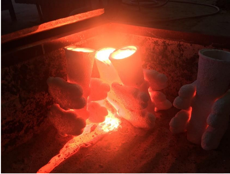
Şekil 48. Döküm Sonrası Soğumaya Bırakılan Seramikler
