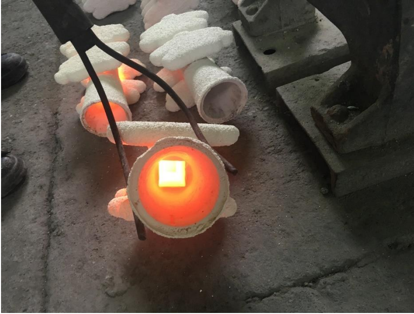
Şekil 45. Yakılma İşlemine Uğramış Seramiğin İç Yüzeyi
