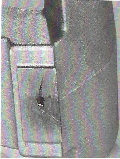
Şekil 35. Yollukta Çekme Hatası
