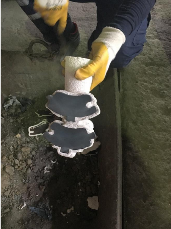
Şekil 50. Seramiği Kırılan Salkımlar
