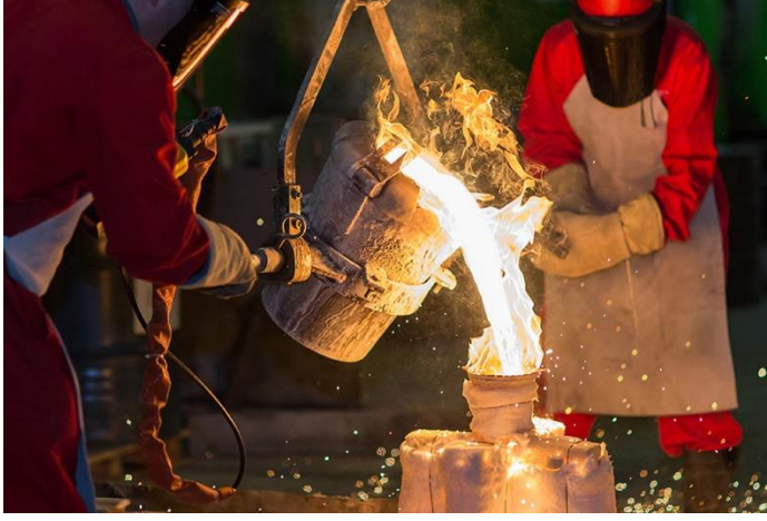
Şekil 18. Hassas Dökümde Döküm Anı
