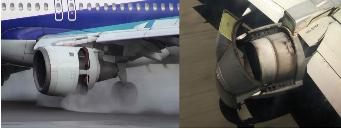
Şekil 6. Pivoting Door ve Bucket Door Uçak Üzerindeki Gösterimi
