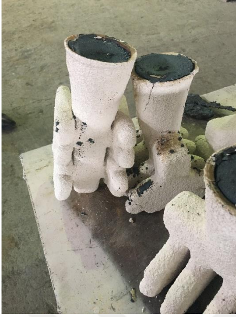
Şekil 49. Döküm Sonrası Soğumuş Kalıpların Görünümü
