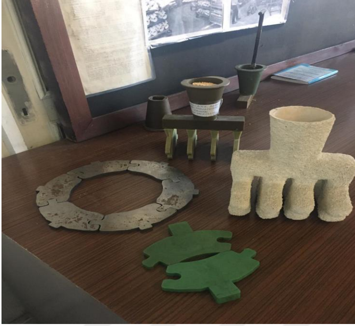
Şekil 41. 1 Nolu Numunenin Mum, Salkım, Seramik Hali ve İşlendikten Sonraki Durumu
