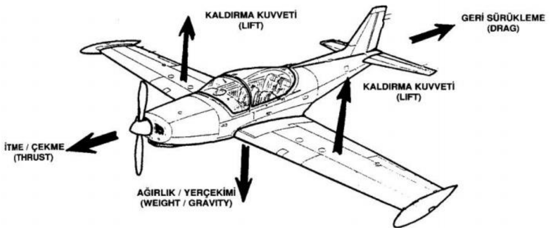
Şekil 1. Uçağa Etki Eden Kuvvetler
