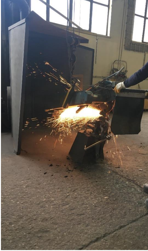
Şekil 51. Parçaların Yolluktan Ayrılması
