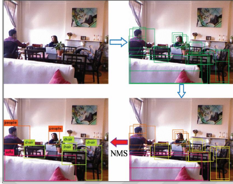
Şekil 3.5. NMS algoritması aşamaları (Wang ve diğ., 2019)
