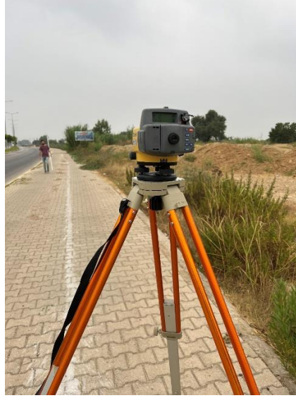
Şekil 5.4. Topcon DL 503 sayısal nivo
